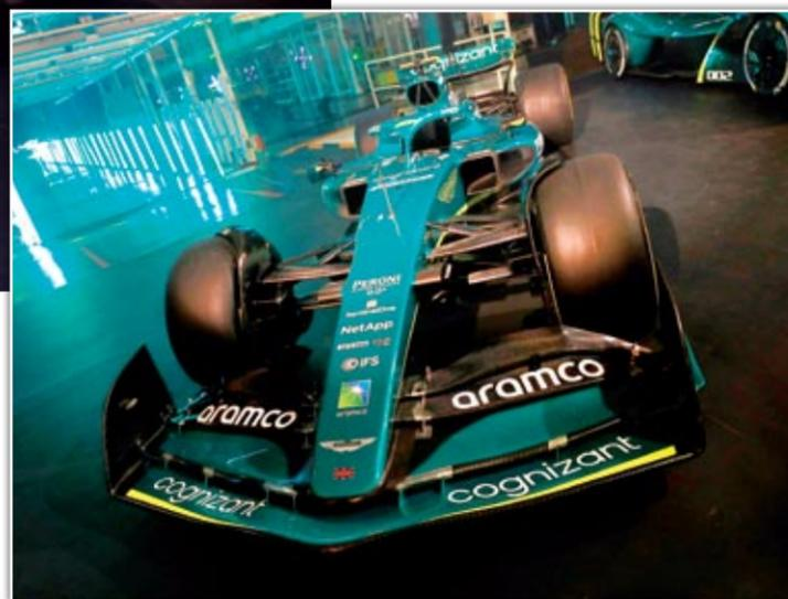
námica en la parte central del monoplaza. Se recupera para ello el famoso 'efecto venturi' de finales de los 70, iniciado por Lotus con sus famosos modelos 78 y 79. El reto consiste en los canales internos con forma de ala (de avión) invertida para crear diferencias de presión entre la superficie superior y la interior, provocando un 'efecto ventosa' que pegue el monoplaza al suelo. Cómo cada equipo ha diseñado esos túneles y los haga tra-
