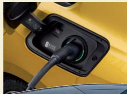
◀ La versión PHEV de 180 CV ofrece una autonomía eléctrica de 60 kilómetros y la batería de 12,4 kWh se puede cargar en menos de dos horas a 7,4 kW.
