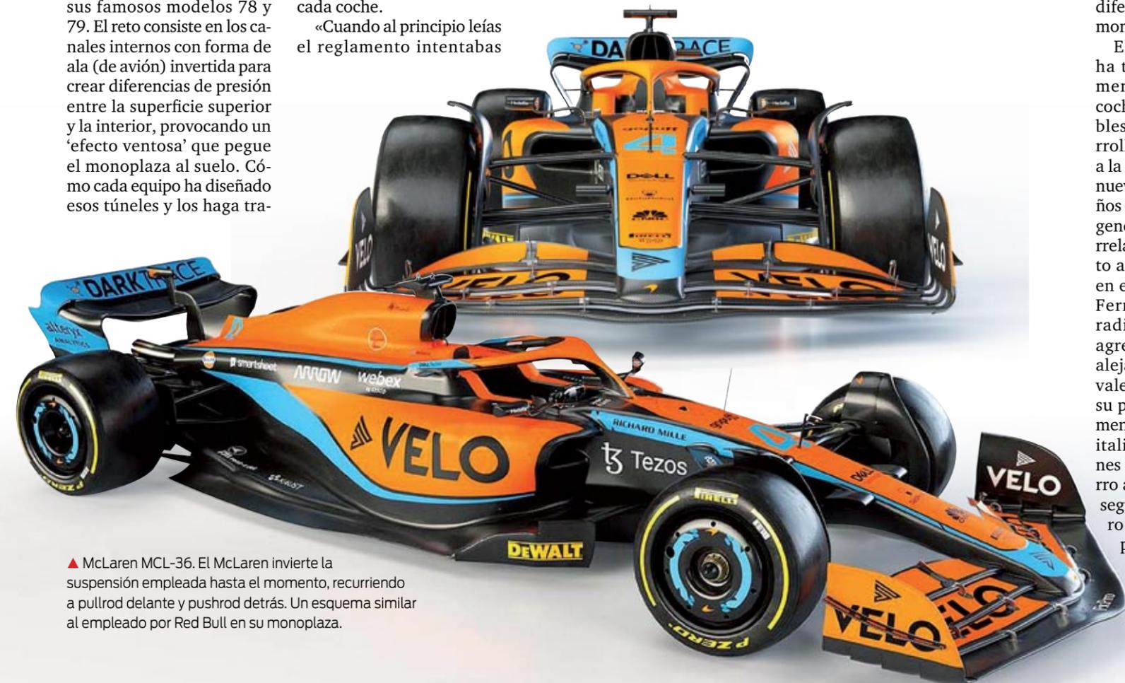
▲ McLaren MCL-36. El McLaren invierte la suspensión empleada hasta el momento, recurriendo a pullrod delante y pushrod detrás. Un esquema similar al empleado por Red Bull en su monoplaza.
