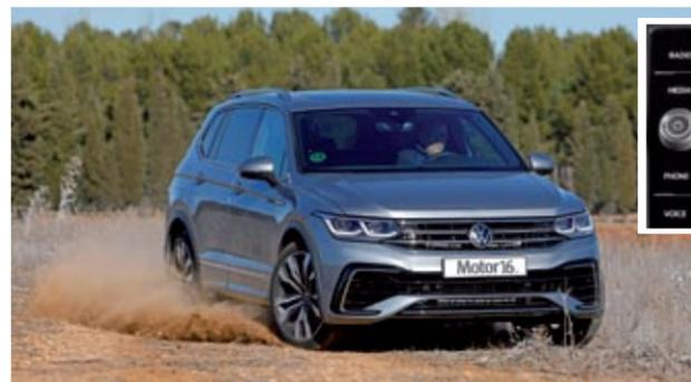
▲ La tracción integral está tarada al 50% entre ejes, con reparto constante en función de las condiciones.
