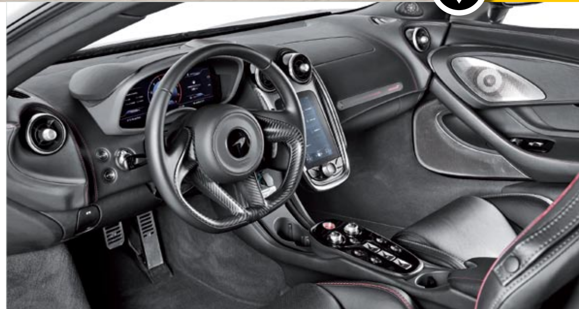
▲ Estos sencillos selectores nos ofrecen los modos Comfort, Sport y Track, tanto del conjunto motor-cambio como del chasis. Hay que activarlos desde el mando inferior Active.
