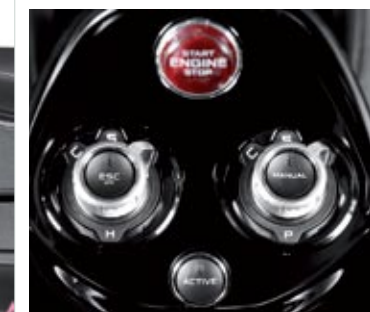
▲ Estos sencillos selectores nos ofrecen los modos Comfort, Sport y Track, tanto del conjunto motor-cambio como del chasis. Hay que activarlos desde el mando inferior Active.
