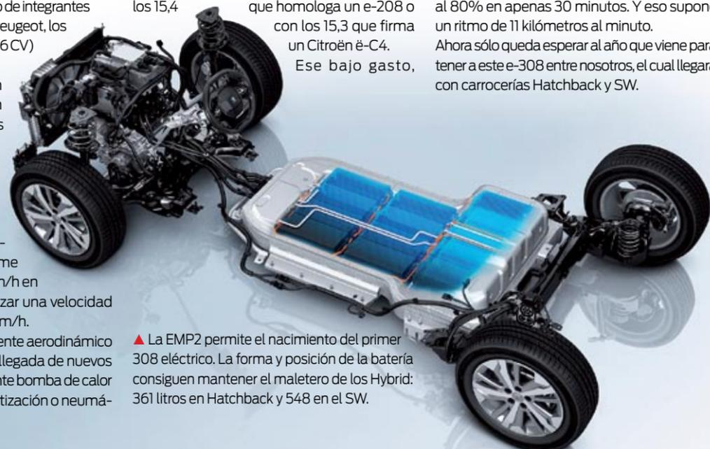
▶ La EMP2 permite el nacimiento del primer 308 eléctrico. La forma y posición de la batería consiguen mantener el maletero de los Hybrid: 361 litros en Hatchback y 548 en el SW.
