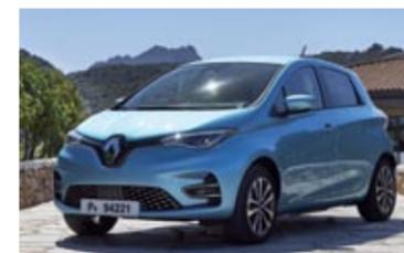
RENAULT ZOE.- Uno de los primeros vehículos eléctricos del mercado, cuenta con dos niveles de potencia, 110 y 136 CV, dos capacidades de batería, 40 y 50 kWh y autonomías de hasta 390 kilómetros. Interior con cinco plazas y 338 litros de maletero.
