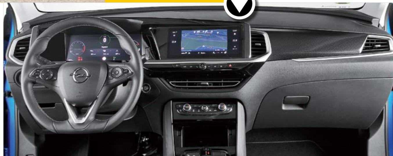
lla de 12 pulgadas, mientras que la central multimedia es de 10, esta última ha obligado a reubicar las salidas centrales de la climatización. El sistema es 100% compatible con Android y con Apple, y cuenta con una plataforma inalámbrica para recargar el teléfono móvil.
