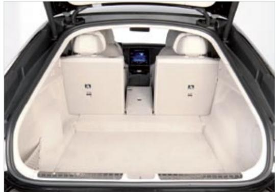
▲▲ Al maletero se accede por un amplio portón, ofreciendo un gran volumen de carga, con 610 litros. Atrás, el espacio para las piernas es enorme, más limitado en la plaza central por la salida de aire, a pesar del poco escalón del túnel central.
