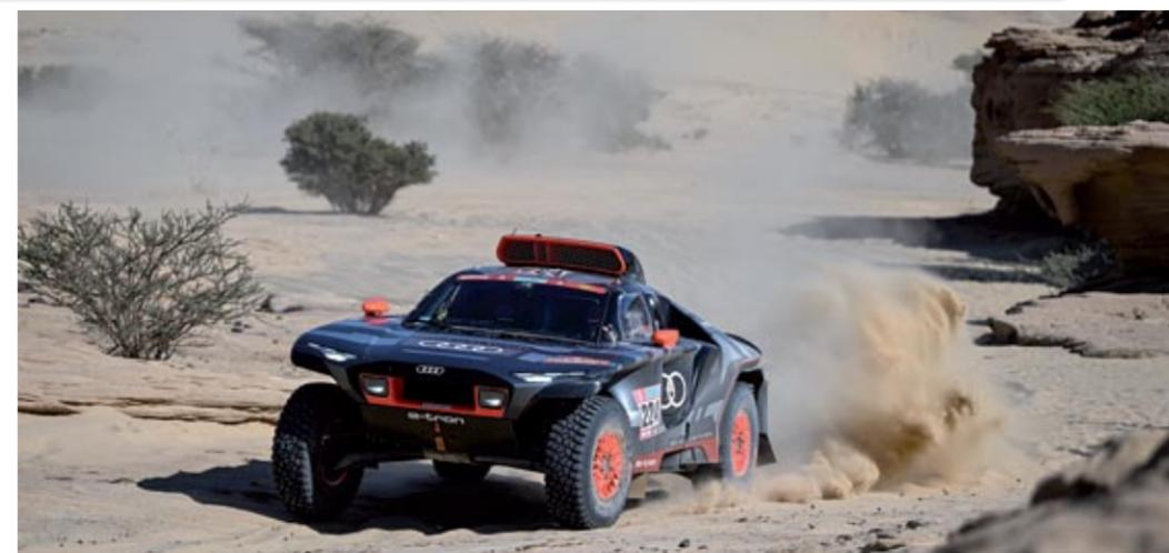
hículo híbrido de las 24 Horas de Le Mans y el Mundial de Resistencia. Tres motores eléctricos y uno térmico constituían la base motriz, con una batería de 52 KW. El motor convencional actúa sobre uno de los eléctricos para recargar ésta, mientras que los otros dos propulsan cada eje.
