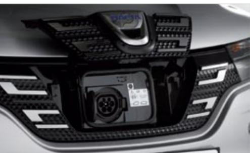
▲ El maletero ofrece 270 litros. La toma de carga se sitúa en el frontal y admite hasta 30 kW en corriente continua en opción.
