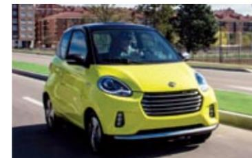
INVICTA ELECTRIC D2S.- Este pequeño vehículo biplaza de 2,81 metros tiene 49 CV, contempla versiones con 17 y 27 kWh de capacidad de batería y hasta 250 kilómetros de autonomía. La máxima potencia de carga es de 3,7 kW.
