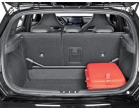
▲ El maletero oscila entre 381 y 1.287 litros de capacidad. De serie equipa rueda de repuesto de emergencia y al abatir los respaldos el refuerzo de las suspensiones estorba.
