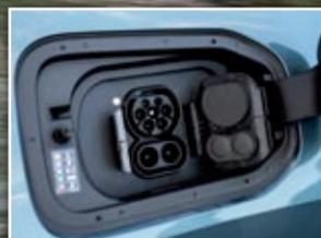
▲ La versión xDrive50 admite hasta 200 kW de carga en corriente continua. En 10 minutos nos permitirá recorrer hasta 150 kilómetros.
