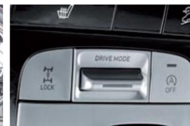
◀ El interior es muy aparente, se remata con calidad y resulta muy amplio. El Drive Mode ofrece los perfiles Eco, Normal y Sport, y las versiones 4x4 contemplan un bloqueo central y un control de descensos.
