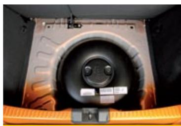
depósito de GLP, con 40 litros de capacidad, algo más de 22 kilos.
