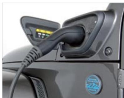
▶▶ El punto de recarga, situado delante, es muy accesible y delata que estamos ante esta versión PHEV. Sólo admite corriente alterna (7,2 kW máximo). Para una recarga completa necesita 2 horas y media.
