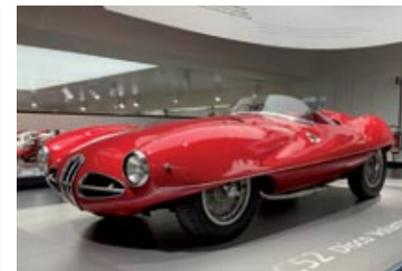
▲ **ALFA ROMEO 52 DISCO VOLANTE**- Diseñado con ayuda del túnel de viento en 1952 por Carrozzeria Touring, utilizaba un motor 2.0 litros con 158 CV, pesaba 735 kg y su velocidad máxima era de 220 km/h.
