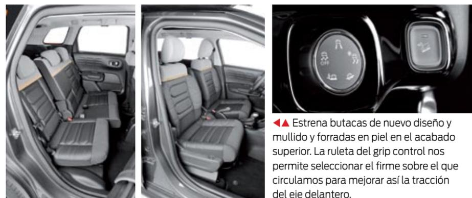
◀▶ Estrena butacas de nuevo diseño y mullido y forradas en piel en el acabado superior. La ruleta del grip control nos permite seleccionar el firme sobre el que circulamos para mejorar así la tracción del eje delantero.
