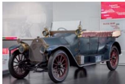
▲ **A.L.F.A. 24 HP**- El primer modelo de la marca italiana se fabricó entre 1910 y 1911. Este turismo de 4,25 metros de largo utilizaba un motor de cuatro cilindros y 42 CV que le permitía alcanzar los 100 km/h.
