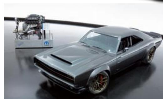
◀ **Dodge Hellephant.** Mopar, el conocido preparador ha creado este remake dotado de un motor V8 Hemi de 1.000 CV y 1.288 Nm.
