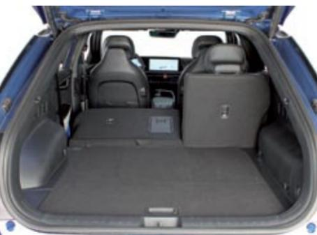
▲▼ El maletero tiene 490 litros (480 con el equipo Meridian) y crece hasta los 1.300. Delante hay otro hueco con 52 litros para guardar los cables de carga.
