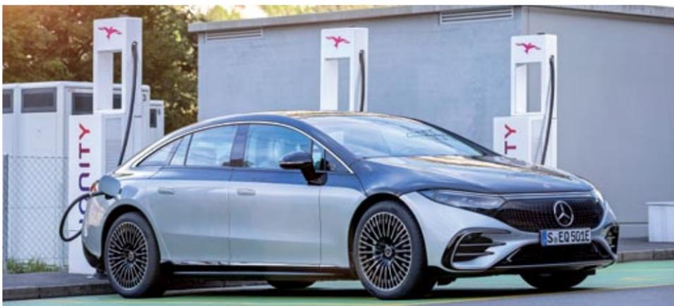
punto de carga, de uso exclusivo por parte del servicio postventa, con un punto de corriente continua a 50 kW, que permite recargar el EQS de 0 a 100% en poco más de 2 horas.
