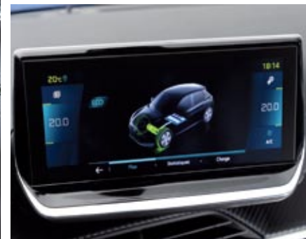
◀▶ La pantalla muestra información del sistema eléctrico, como el flujo de energía entre la batería, el motor y las ruedas.
