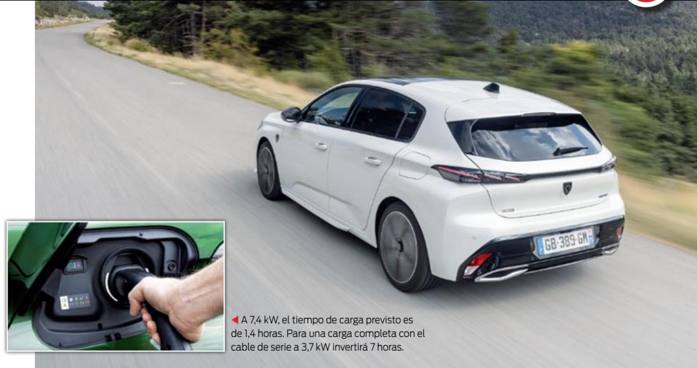
◀ A 7,4 kW, el tiempo de carga previsto es de 1,4 horas. Para una carga completa con el cable de serie a 3,7 kW invertirá 7 horas.
