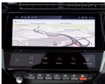
▲▲ La conectividad del 308 es la más novedosa de la marca, con el nuevo sistema Peugeot i-Connect. Su función inalámbrica Mirroring permite interactuar con dos teléfonos al mismo tiempo vía Bluetooth.
