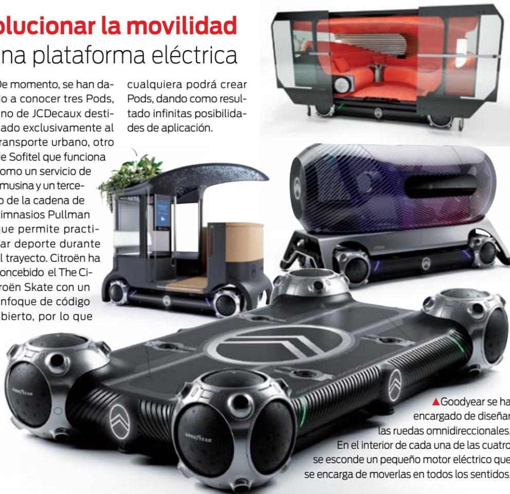
▲ Goodyear se ha encargado de diseñar las ruedas omnidireccionales. En el interior de cada una de las cuatro se esconde un pequeño motor eléctrico que se encarga de moverlas en todos los sentidos.
