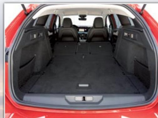
◀◀ Muy amplio. El maletero de la carrocería SW ofrece 608 litros de capacidad (548 en las dos versiones PHEV). El suelo se puede colocar en dos alturas, y cuenta con portón automático opcional.
