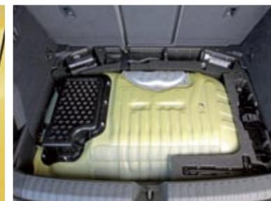
▲ La batería solo se puede cargar con corriente alterna. Para una recarga completa invertiremos 5 horas, a 2,9 kW. Absoluto blindaje para la batería en el suelo del maletero.
