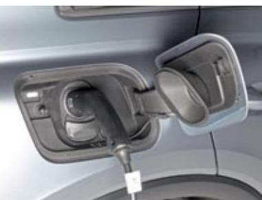
▲▼ Admite cargas de hasta 125 kW en corriente continua que permite almacenar un 80 por ciento en 38 minutos. Las llantas son muy aerodinámicas.
