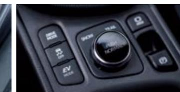
◀▶ Buena habitabilidad, con una cota de altura notable. Tras la palanca del cambio, teclas para los modos de conducción y una rueda para elegir, en los 4x4, el modo nieve o trail.
