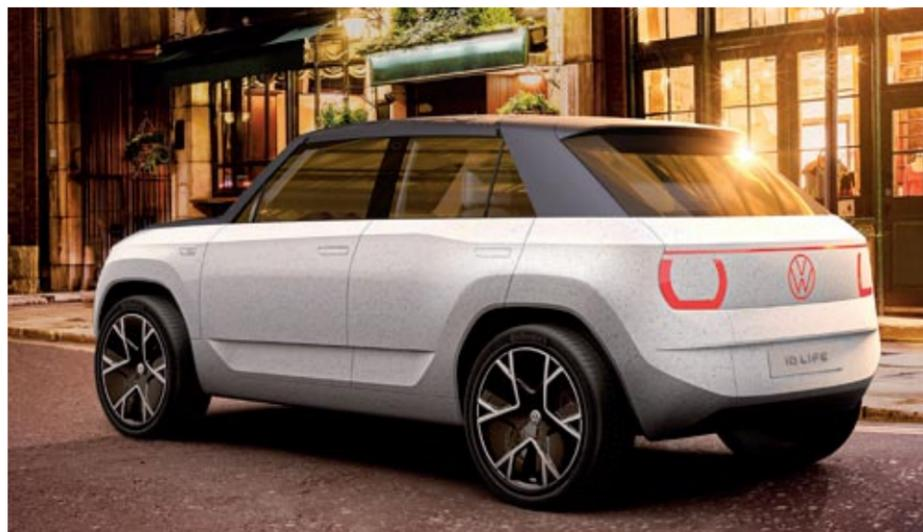
▲ El barniz de la carrocería, el capó, el techo y los neumáticos están fabricados con material reciclado a partir de botellas de PET, aceite orgánico, caucho natural o cáscara de arroz.
