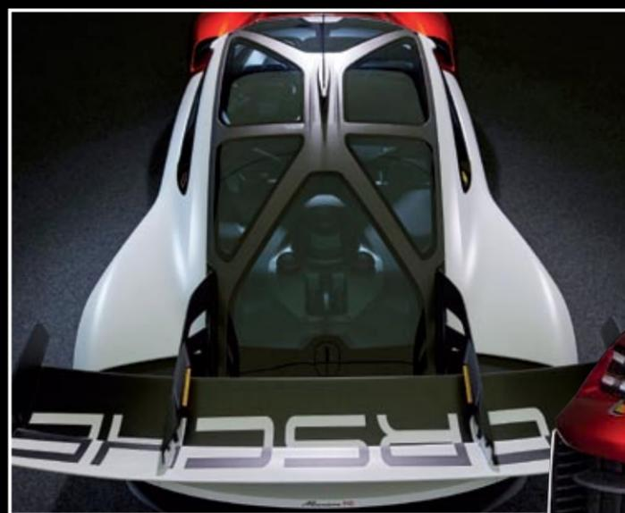
◀ El exoesqueleto de fibra del techo sustituye a la tradicional jaula de seguridad.
