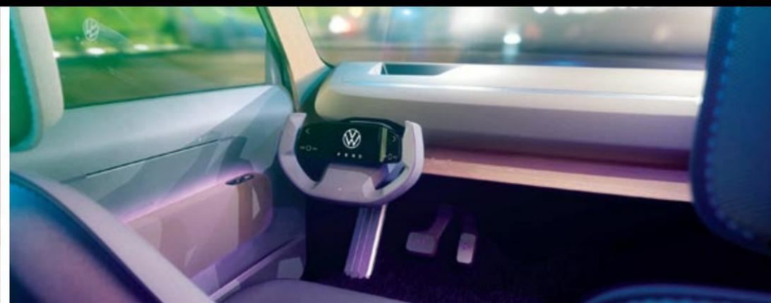
◀ El interior es minimalista, como el exterior, y está completamente digitalizado. No hay ningún botón y las principales funciones de conducción se gestionan a través de una pantalla táctil integrada en el volante hexagonal. El equipo multimedia se controla a través del smartphone, integrándolo en el sistema operativo del coche
