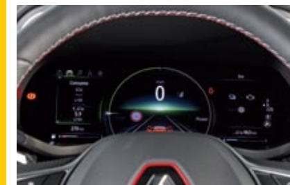
▲ El cuadro digital cambia de configuración según sea el perfil de conducción elegido.
