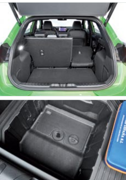
▲▲ Como su motor no tiene sistema MHEV, el ST no necesita la batería de apoyo que resta volumen al Megabox. Y con esos 80 litros totaliza 456.
