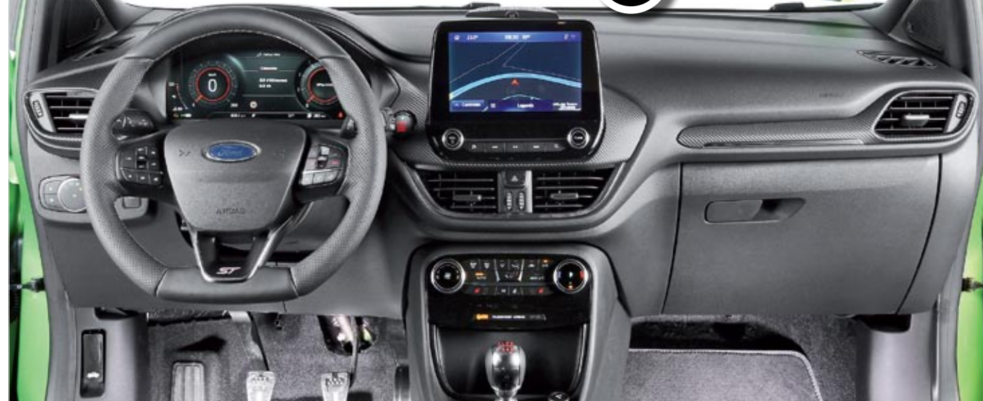
▲▲ Aunque el cuadro de instrumentos digital no es tan configurable como en coches de otras marcas, todo está claro y disfrutamos de mucha información adicional: temperaturas, presiones...
