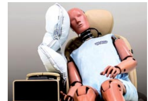
▲ El airbag central está diseñado para evitar lesiones en la cabeza de los pasajeros delanteros.
