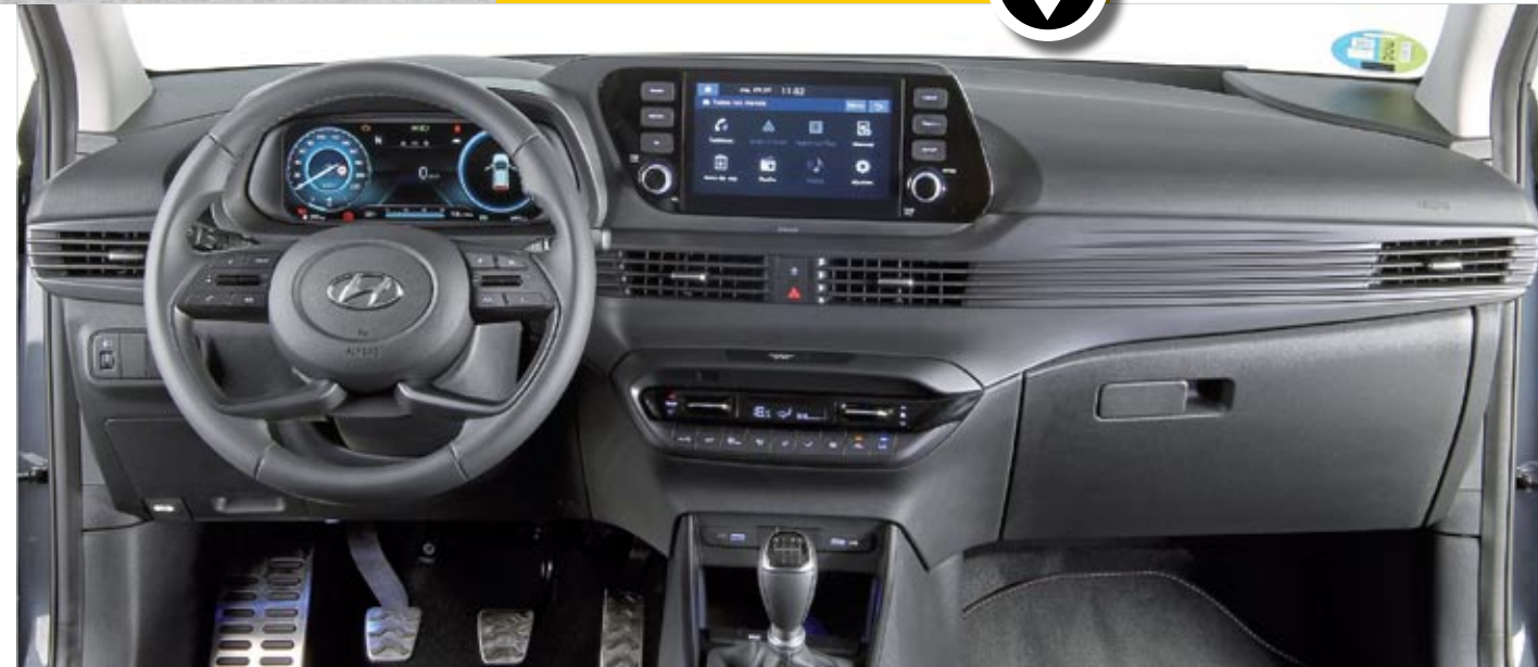
▲▲ La pantalla digital de la instrumentación, de 10,25", cambia el color de los relojes según el modo de conducción seleccionado (ECO, Comfort y Sport).
