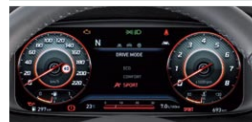
▲▲ La pantalla digital de la instrumentación, de 10,25", cambia el color de los relojes según el modo de conducción seleccionado (ECO, Comfort y Sport).
