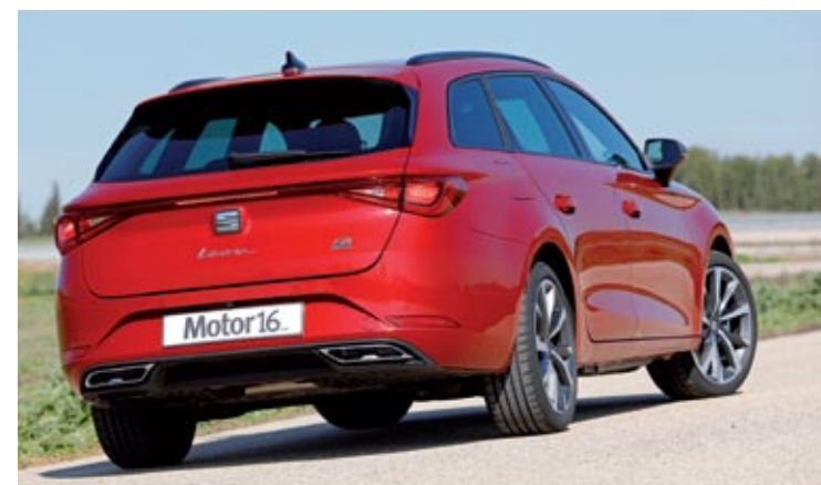
▲ Los 225/45 R17 que monta de serie el FR son perfectos, pero nuestra unidad equipaba los 225/40 R18 opcionales, con los que gana precisión.
