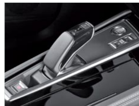
◀▲ El cambio automático e-EAT8 es el EAT8, pero adaptado a su personalidad híbrida y eléctrica. Por ejemplo, tiene un modo B que incrementa la retención.
