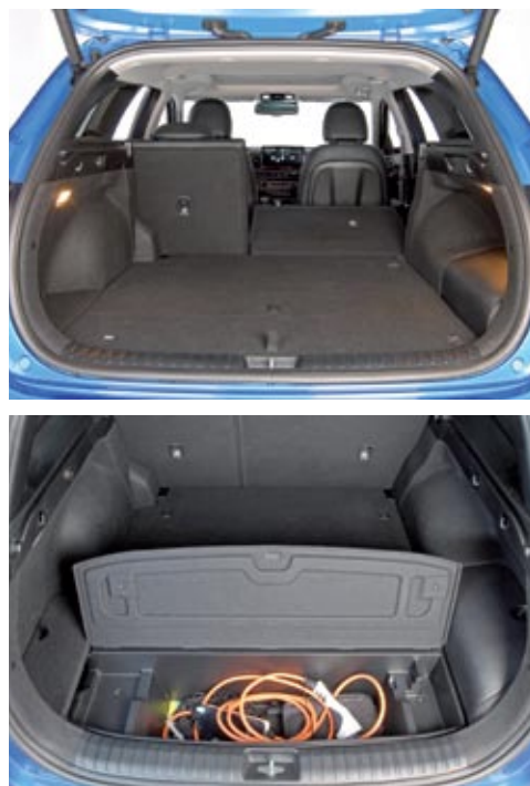
▲▲ El maletero ofrece 437 litros y debajo presenta huecos para el cable o el estor cubre-equipajes. El portón es eléctrico con función manos libres de serie.
