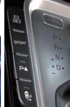
▲ El cambio es automático con doble embrague de seis relaciones. El mando EV fuerza el modo eléctrico.
