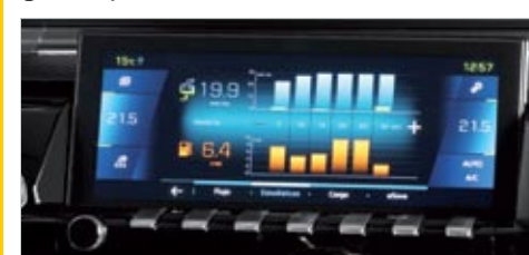
▲▼ El cuadro digital permite elegir entre varios diseños, e incluso muestra el mapa –el navegador es de serie–. Y la pantalla central táctil de 10 pulgadas ofrece estadísticas específicas, como el consumo de gasolina y electricidad, la reserva de batería...
