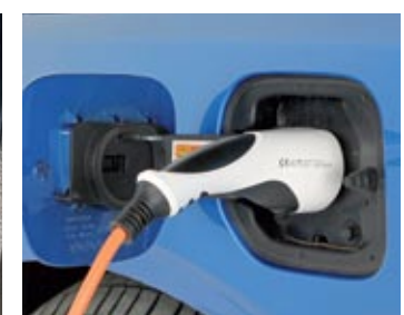
◀ En una toma de 3,7 kW, en apenas 2 horas y 35 minutos se puede cargar la batería de 8,9 kWh.
