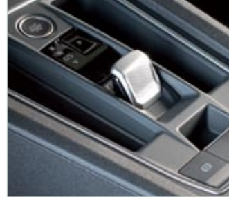
▲ Más que una palanca, el cambio tiene selector, pero podemos seguir cambiando de forma manual secuencial con las levas del volante. Hay programas D y S.
