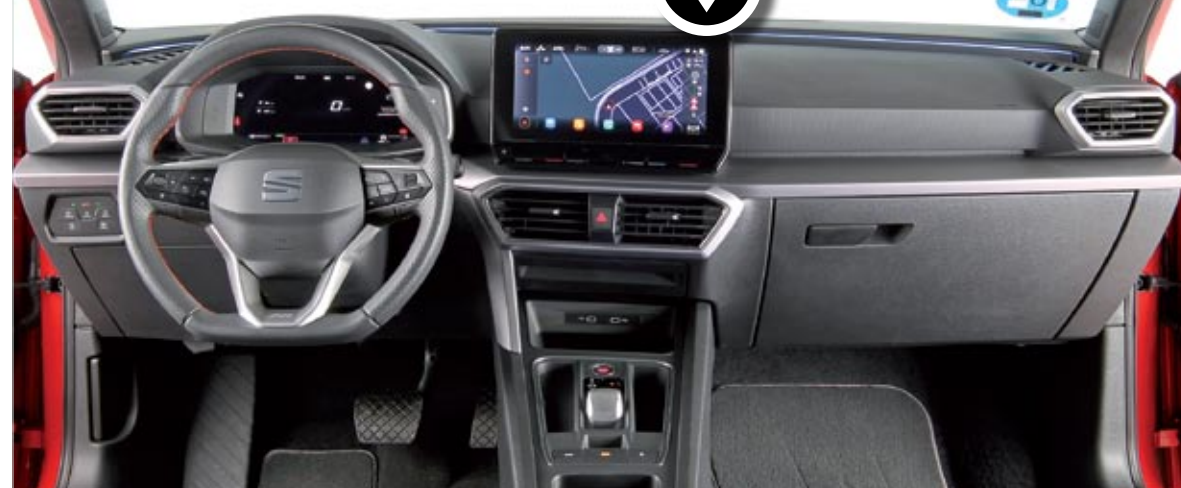
▲ Más que una palanca, el cambio tiene selector, pero podemos seguir cambiando de forma manual secuencial con las levas del volante. Hay programas D y S.
