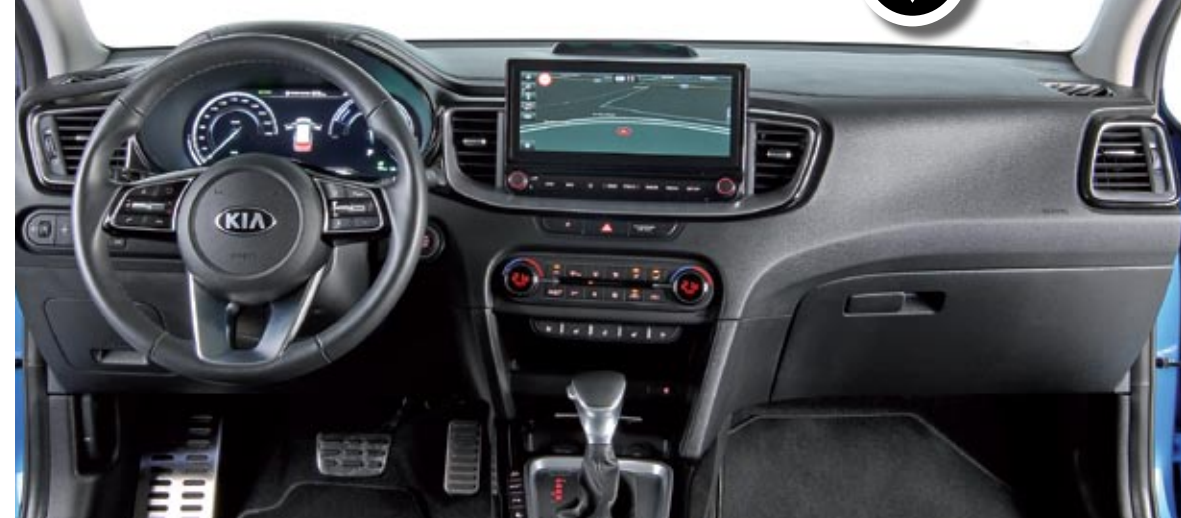
▲ El cambio es automático con doble embrague de seis relaciones. El mando EV fuerza el modo eléctrico.
