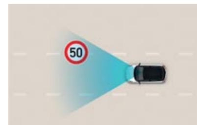
▲ Asistente Límite de Velocidad. Mediante el lector de señales controla los límites de velocidad.
