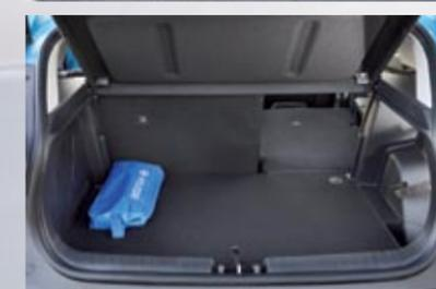
▲ Gran capacidad de maletero con 411 litros; original sistema de plegado de la bandeja, que se retrae sobre el respaldo posterior para permitir aprovechar la altura al techo.
