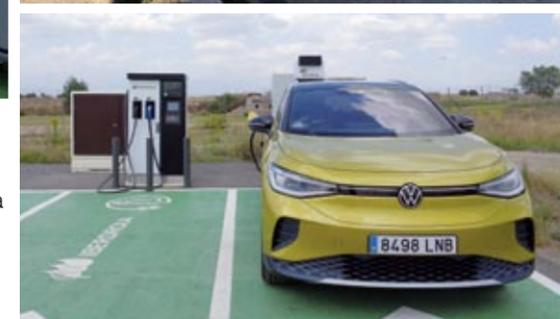
Entre Madrid y Sevilla, Iberdrola tiene dos puntos de recarga de 150 kW. Y los aprovechamos para recargar sus baterías de 77 kWh de capacidad. A esa potencia pasan del 20 al 80% en tan solo 38 minutos. Metropol Parasol se llama el proyecto que enlaza la plaza de la Encarnación de Sevilla.
