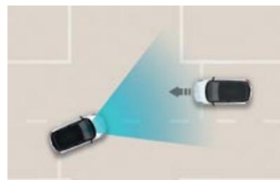
▲ Asistente Anticolisión Frontal (FCA). Con función para evitar colisiones en intersecciones.
