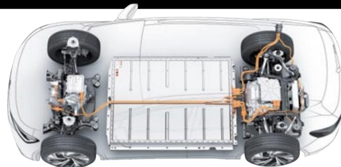
▲ Los ID.4 nacen de la plataforma MEB. Sus baterías de 58 kWh pesan 344 kilos y las de 82 kWh 493. El motor añade otros 90 kg.
