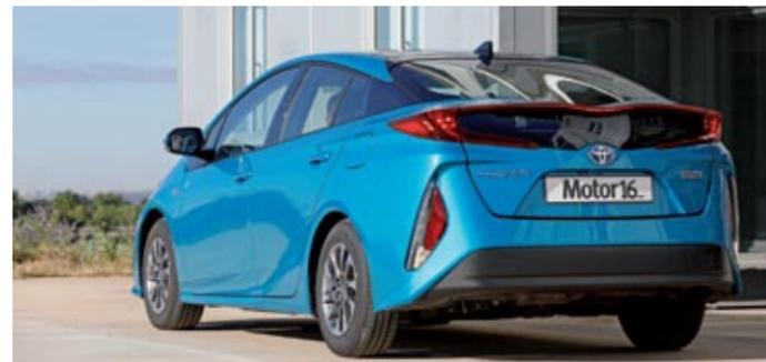
◀ A pesar de su luna dividida, la visibilidad es buena. Hay cámara trasera, pero no sensores de parking. La estructura del portón es de fibra de carbono, que en el interior queda a la vista.
