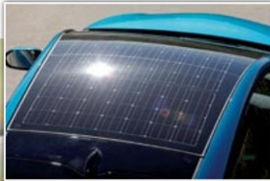
▲ Las placas las fabrica Panasonic y recuperan energía del sol para recargar sus baterías tanto en marcha como en estático.
