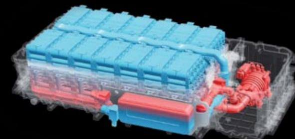
▲ La batería de los AMG híbridos enchufables se ubica por delante del eje trasero, tiene una capacidad de 6,1 kWh y pesa 89 kilos.
