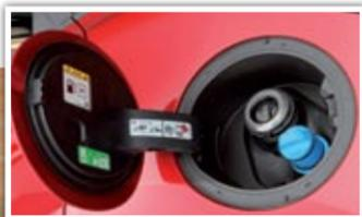
◀ Junto a la boca de llenado de gasolina va la del AdBlue para el tratamiento de NOx. La capacidad es de 13,5 litros.
