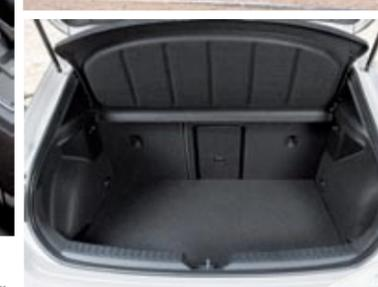
▲▼ Los tres depósitos de GNC suman 17,3 kilos, y con ese gas podremos cubrir casi 500 kilómetros. A cambio, el maletero se reduce a 300 litros en el León de cinco puertas, y a 480 en el Sportstourer.
