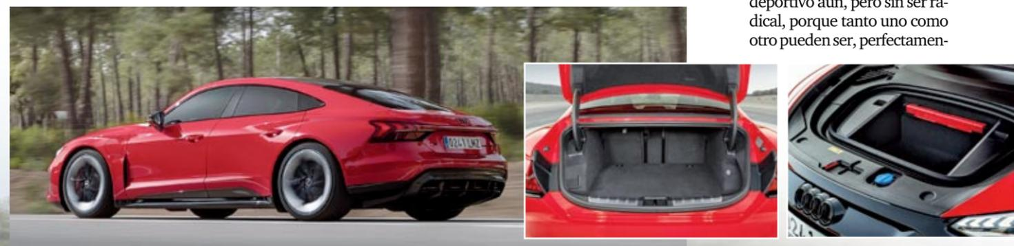
▲▲ El maletero, profundo y con boca estrecha, ofrece 405 litros. Y delante hay otros 81 bajo el capó.
