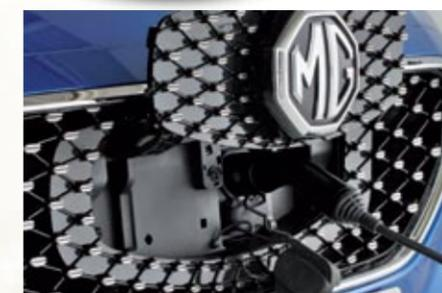
◀ La toma de carga está en el frontal y admite 50 kW en corriente continua. No tiene iluminación y hay que agacharse para encontrar el conector.
