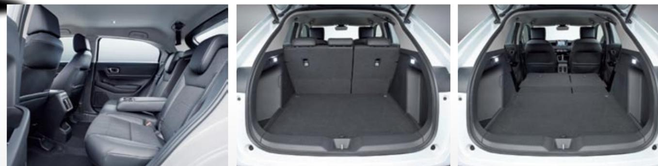
▲ Salidas de aire traseras y 35 milímetros más de espacio para las piernas en la segunda fila que en la generación anterior. El maletero se beneficia de un borde de carga más bajo y de un portón automatizado, y si abatimos por completo el respaldo posterior el suelo queda totalmente horizontal.
