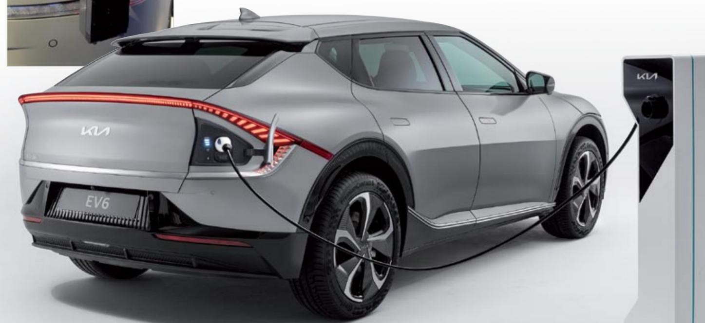
CON LA CARGA ULTRARRÁPIDA DE 800 VOLTIOS PODRÁ RECARGARSE LA BATERÍA DEL 10 AL 80 POR CIENTO EN SOLO 18 MINUTOS
