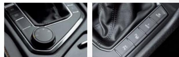
El Tarraco e-Hybrid conserva la rueda que permite elegir modo de conducción entre Confort, Eco, Sport e Individual. Pero a la derecha de la palanca de cambio incluye dos botones específicos: s-Boost y e-Mode.
