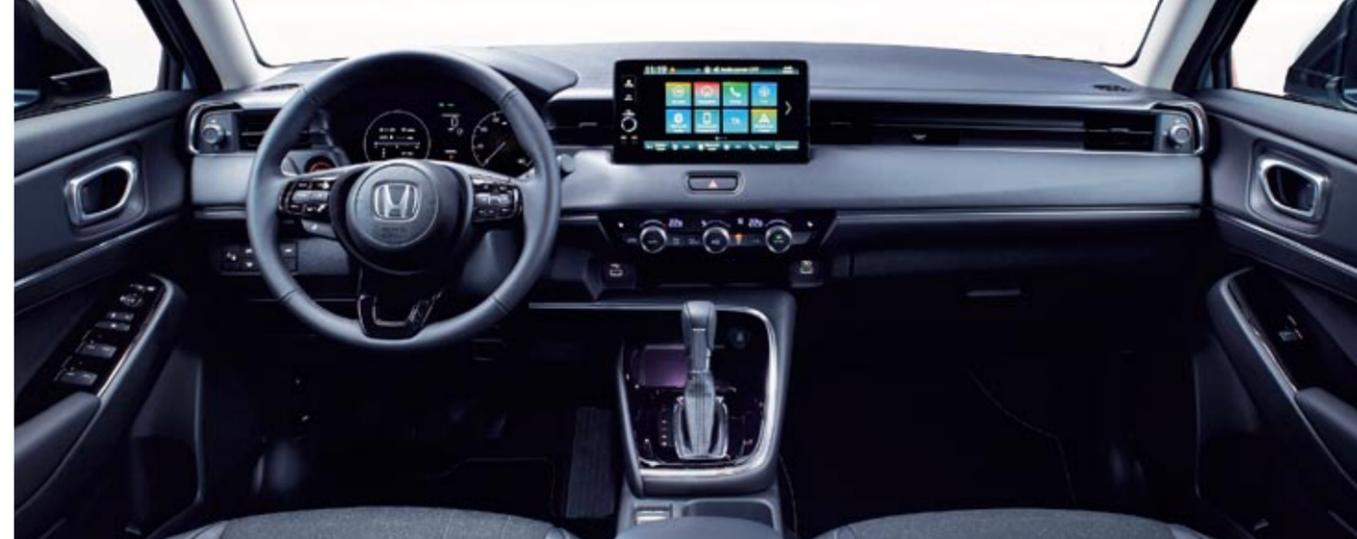
▲ En la instrumentación digital, de 7 pulgadas, podemos elegir la cantidad de información. Y en el centro del tablero va la pantalla táctil, de 9 pulgadas.
