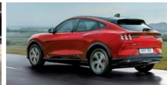
◀ Disponible con baterías de ion-litio de 75,7 y 98,7 kWh, el Mustang Mach-E admite recargas de 150 kW, de modo que en 10 minutos carga para cubrir 119 kilómetros más.
