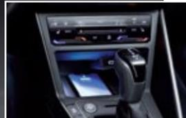
Las versiones con Climatronic estrenan un panel en la consola con mandos de climatización táctiles.
