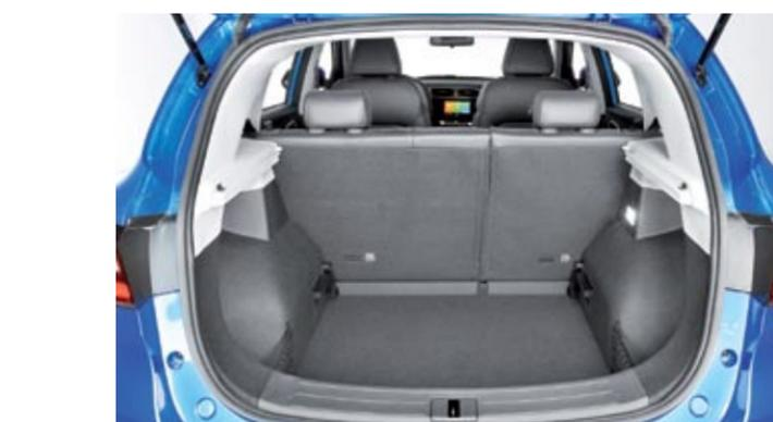
▲▲ El interior es amplio y se remata con una calidad percibida realmente buena. El maletero ofrece una capacidad de 448 litros y el piso se puede situar a dos alturas. No hay reposacabezas central trasero.
