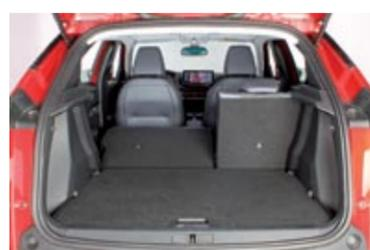
▲ Maletero de 434 litros, con formas regulares y ampliable a 1.496 litros. ¿Mejorable? sí, con una banqueta trasera corredera.
