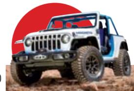
De cara al 'Easter Jeep Safari 2021', Jeep y Jeep Performance Parts han creado varios 'concept cars', como el Wrangler Magneto, con motor eléctrico de 285 CV y baterías con 70 kWh de capacidad.
