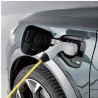
▲▼ Podemos cargar la batería de 13,0 kWh a una potencia máxima de 3,7 kW, en 3 horas y 42 minutos. Las llantas de 19 pulgadas son de serie.
