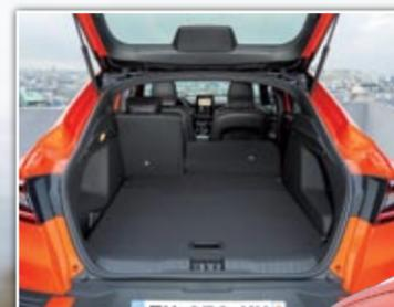
◀ Maletero enorme, con 513 litros –ampliables hasta 1.296– en las versiones TCe de hibridación suave y 480 en el Arkana E-Tech.
