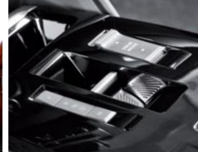
▲ La palanca del cambio es diminuta, pero podemos cambiar secuencialmente entre sus ocho relaciones mediante las levas del volante.
