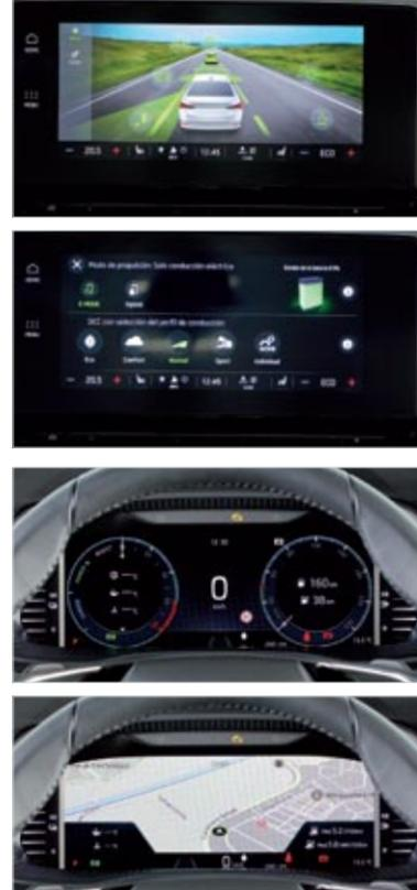
▲ Sobre estas líneas, dos vistas de la instrumentación digital configurable Virtual Cockpit, de 10,2 pulgadas. Más arriba, otras dos de la pantalla central, de 10 pulgadas.
