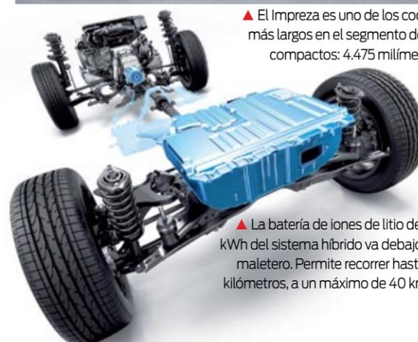
▲ La batería de iones de litio de 0,6 kWh del sistema híbrido va debajo del maletero. Permite recorrer hasta 1,6 kilómetros, a un máximo de 40 km/h.
