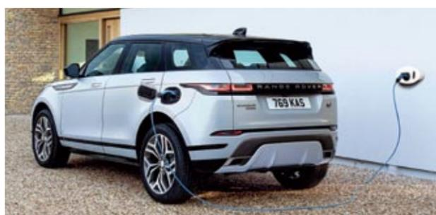
▲ Cuenta de serie con un cable Tipo 2 que permite recargar la batería en 6 horas y 42 minutos usando un toma doméstica.
