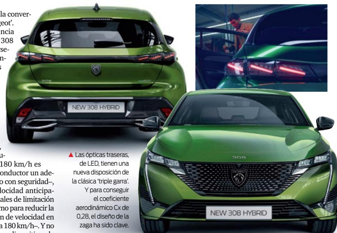
▲ Las ópticas traseras, de LED, tienen una nueva disposición de la clásica ‘triple garra’. Y para conseguir el coeficiente aerodinámico Cx de 0,28, el diseño de la zaga ha sido clave.
