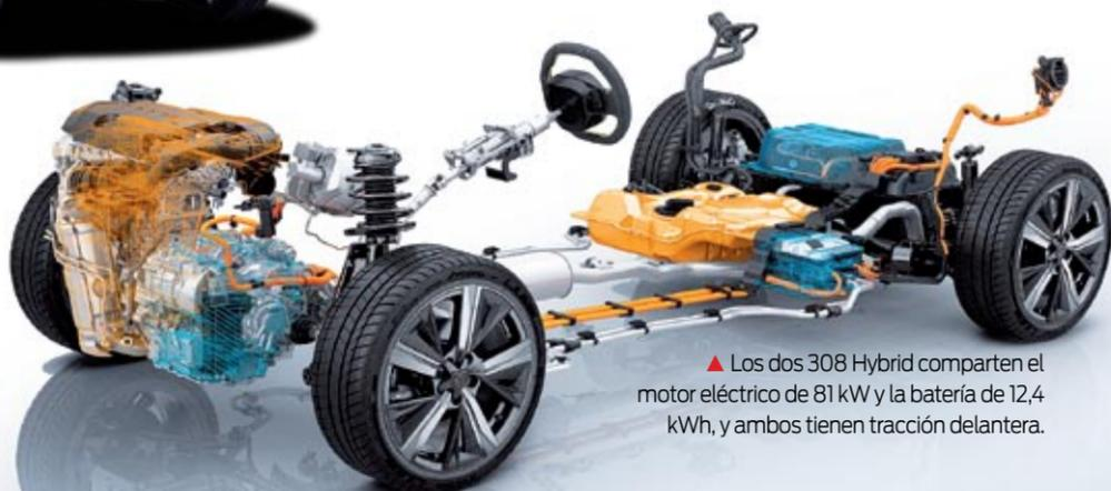
▲ Los dos 308 Hybrid comparten el motor eléctrico de 81 kW y la batería de 12,4 kWh, y ambos tienen tracción delantera.
