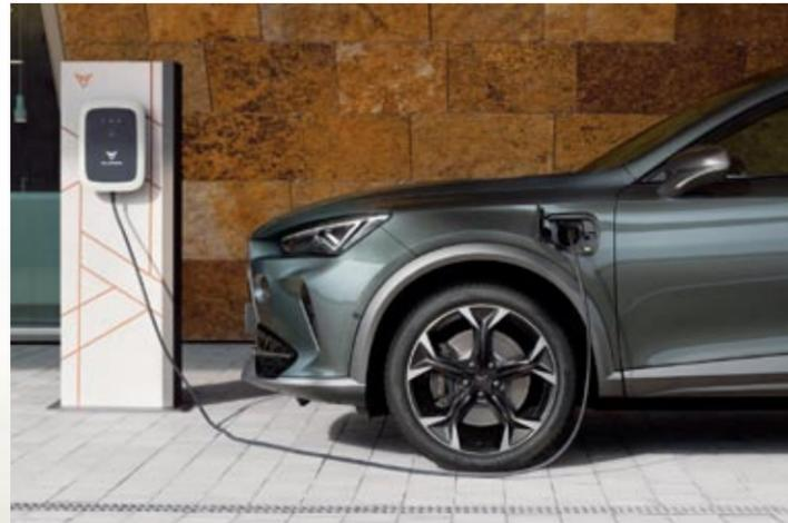
▲ La batería se puede recargar en 3 h. 33 m. con un Wallbox de 3,6 kW, o en poco menos de 5 horas con un enchufe doméstico de 2,3 kW.
