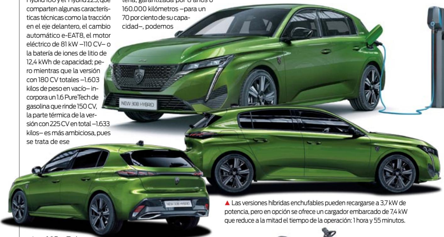
▲ Las versiones híbridas enchufables pueden recargarse a 3,7 kW de potencia, pero en opción se ofrece un cargador embarcado de 7,4 kW que reduce a la mitad el tiempo de la operación: 1 hora y 55 minutos.
