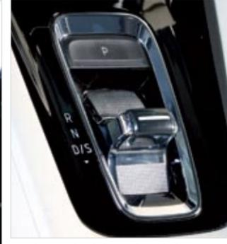
▲ El mando del cambio de la consola solo sirve para seleccionar las posiciones. Pero hay levas en el volante para el manejo secuencial.
