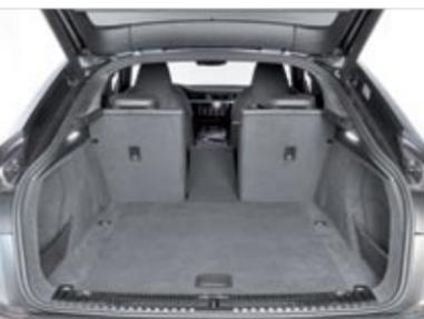
◀ El maletero principal tiene 555 litros, ampliables a 1.665 si abatimos el respaldo 40:20:40. Y delante hay otro, con 60 litros.
