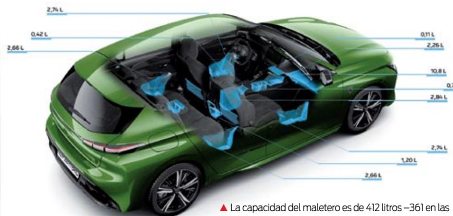
▲ La capacidad del maletero es de 412 litros –361 en las versiones Hybrid–, ampliable a 1.323 si abatimos el respaldo trasero –medición en litros de agua, y no según la más realista norma VDA–. Los huecos repartidos por el habitáculo para colocar objetos suman 34 litros.
