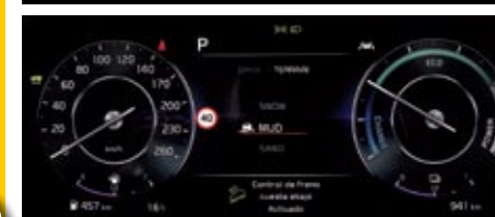
◀ Toda la gama incluye el cuadro de instrumentos Supervision de 12,3 pulgadas, que se configura según el modo de conducción, aunque no tiene cuentavuelvas ni en Sport. El Head-up Display es opcional.
