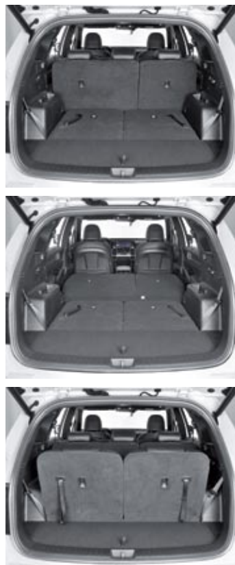
▲ Con cinco plazas en uso, el volumen del maletero oscila entre 608 y 813 litros, según movamos la segunda fila.
