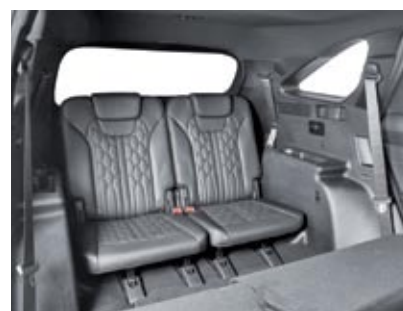
▲▲ La tercera fila es solo apta para chavales; y no por falta de espacio para piernas, sino por la escasa altura –83 centímetros es poco– y la elevada posición del suelo. En cambio, las dos primeras filas son magníficas por amplitud y confort.
