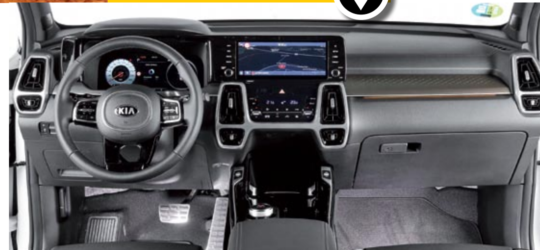
▲▲ Junto a la rueda de selección del cambio, que es más grande, va otra con la que elegimos los modos de conducción y, pulsándola, los programas 'off road'. Todo fácil.
