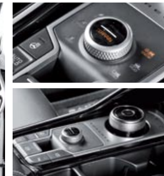
▲▲ Junto a la rueda de selección del cambio, que es más grande, va otra con la que elegimos los modos de conducción y, pulsándola, los programas 'off road'. Todo fácil.
