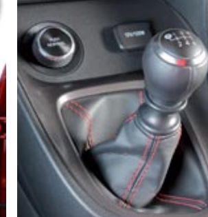
▲ Cambio manual de seis marchas prácticamente perfecto: rápido, preciso, con recorridos cortos y desarrollos muy 'racing'...
