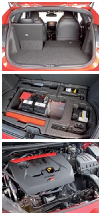
▲ Maletero 112 litros más pequeño que el del Yaris normal, pues bajo su suelo va la batería. Es para equilibrar masas y porque el motor 'llena' todo.
