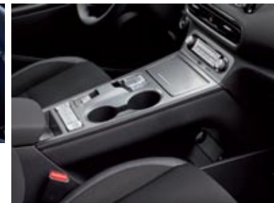
▲► La pantalla táctil central es de 8 pulgadas y de serie, y puede llegar a 10,25 pulgadas, el mismo tamaño que el cuadro digital. El selector del cambio se maneja con unos botones en la consola central.
