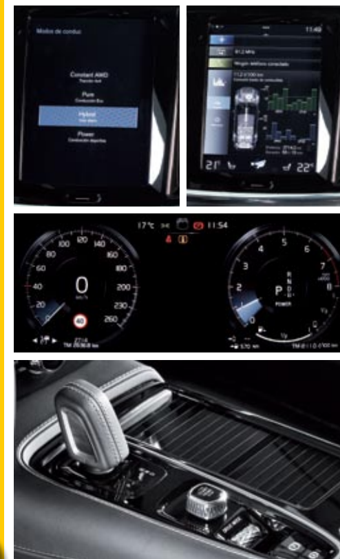
▲ ▲ Hay cuatro modos de conducción: Constant AWD, Pure, Hybrid y Power. Para acceder a las funciones que permiten guardar carga de la batería para más tarde o recargarla en marcha hay que usar la pantalla central y buscar la página. Y tampoco el selector del cambio enamora.
