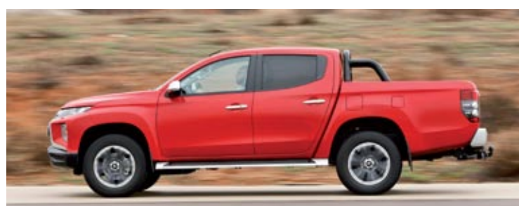
▲ Los 150 CV del propulsor mueven con cierta soltura un conjunto que supera los 2.100 kilos. Detrás monta ballestas y frenos de tambor.
