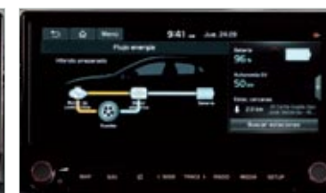
▲▲ La instrumentación es un panel digital de 12,3 pulgadas que Kia llama Supervision, y cuyo diseño podemos configurar un poco, aunque no muestre cuentavueeltas ni en el modo Sport –arriba, izquierda–. La pantalla central táctil, de 10,25 pulgadas, tiene navegador e infinidad de funciones energéticas.
