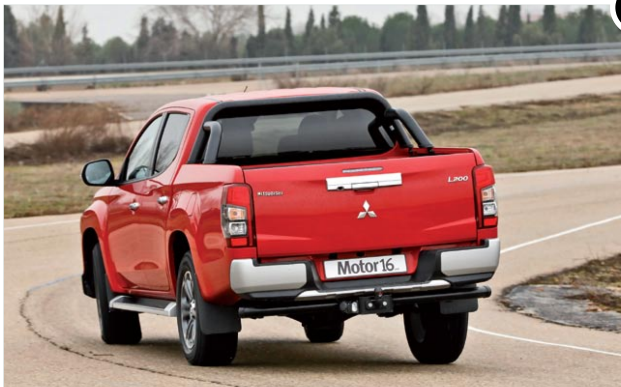
▲▲ La generosa 'bañera' admite hasta 1.075 kilos de carga. Por debajo se ubica la rueda de repuesto.
