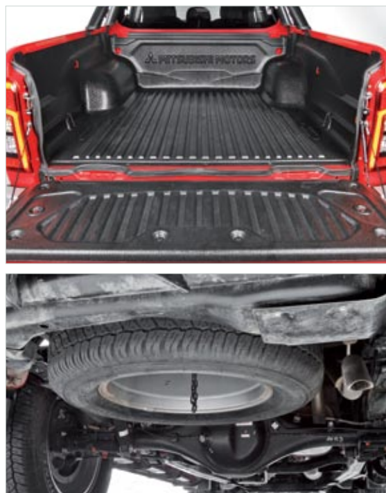
▲▲ La generosa 'bañera' admite hasta 1.075 kilos de carga. Por debajo se ubica la rueda de repuesto.
