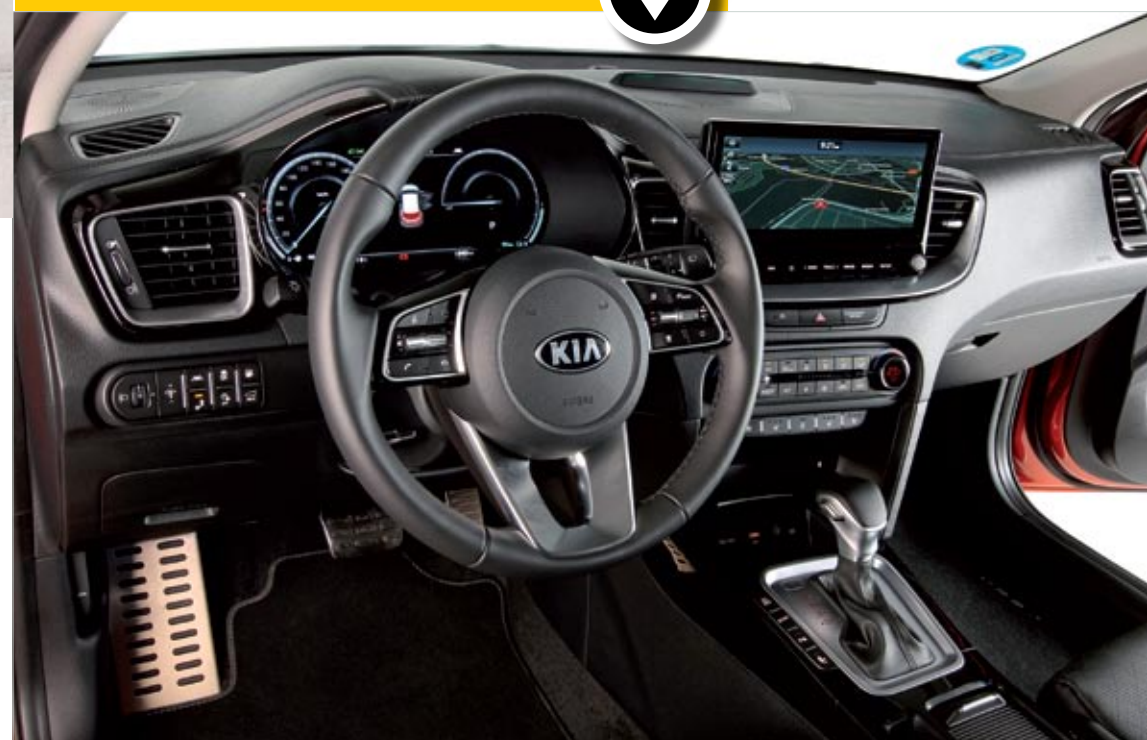
▲▲ La instrumentación es un panel digital de 12,3 pulgadas que Kia llama Supervision, y cuyo diseño podemos configurar un poco, aunque no muestre cuentavueeltas ni en el modo Sport –arriba, izquierda–. La pantalla central táctil, de 10,25 pulgadas, tiene navegador e infinidad de funciones energéticas.
