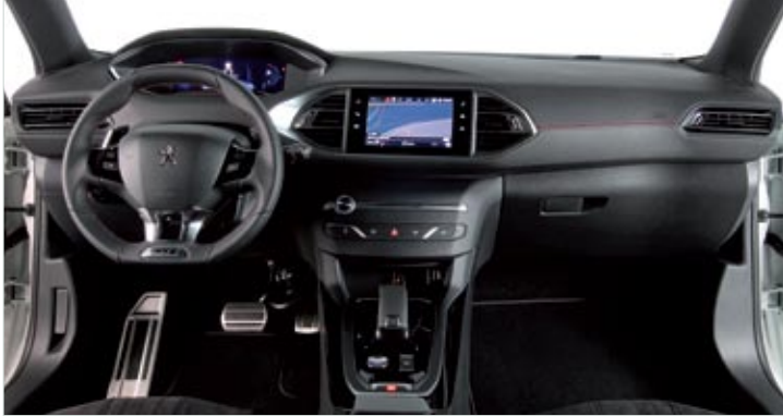
▲ El puesto de conducción i-Cockpit, con un volante pequeño y bajo, y el cuadro por encima, es un tanto particular. El cambio automático con convertidor de par tiene 8 velocidades.
