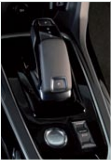
▲ El puesto de conducción i-Cockpit, con un volante pequeño y bajo, y el cuadro por encima, es un tanto particular. El cambio automático con convertidor de par tiene 8 velocidades.
