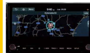
▲▲ La instrumentación es un panel digital de 12,3 pulgadas que Kia llama Supervision, y cuyo diseño podemos configurar un poco, aunque no muestre cuentavueeltas ni en el modo Sport –arriba, izquierda–. La pantalla central táctil, de 10,25 pulgadas, tiene navegador e infinidad de funciones energéticas.
