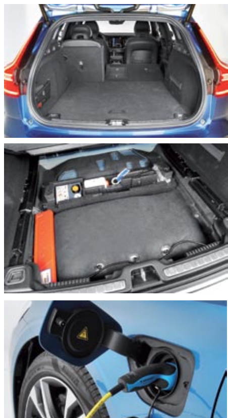
▲ ▼ Maletero de 529 litros, como en las versiones 'normales' del V60. La batería, de 11,6 kWh, podemos recargarla en puntos de hasta 3,7 kW, lo que reduce la operación a tres horas. El cable doméstico que trae es un poco corto.
