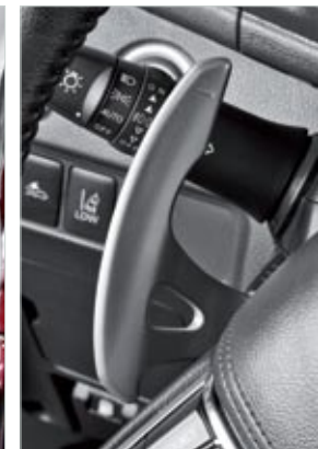
▲ Las generosas levas detrás del volante permiten cambiar de manera secuencial entre las seis relaciones de la caja automática.
