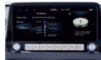
▲► La pantalla táctil central es de 8 pulgadas y de serie, y puede llegar a 10,25 pulgadas, el mismo tamaño que el cuadro digital. El selector del cambio se maneja con unos botones en la consola central.
