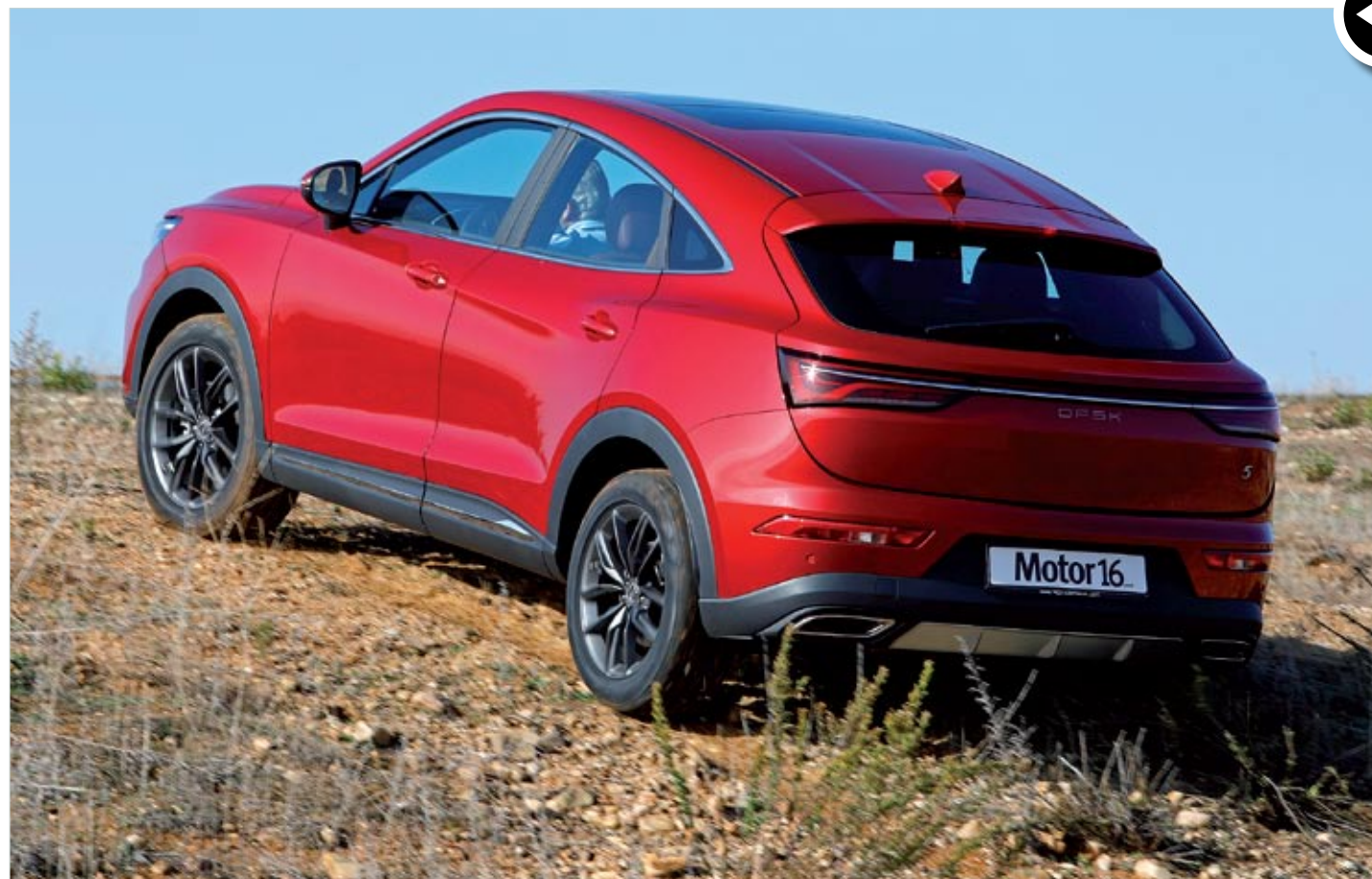
El depósito de GLP de 68 litros situado bajo el piso del maletero impide que el coche pueda llevar rueda de repuesto. Y el maletero, aunque no es grande, es muy aprovechable.
