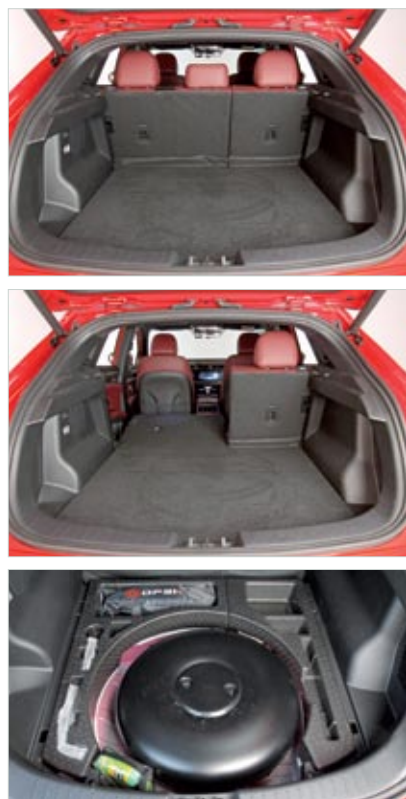
El depósito de GLP de 68 litros situado bajo el piso del maletero impide que el coche pueda llevar rueda de repuesto. Y el maletero, aunque no es grande, es muy aprovechable.
