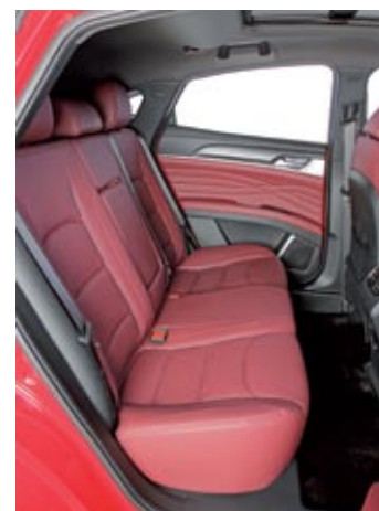
▲ Entre otros equipamientos destacables, el F5 lleva botón de arranque, asientos de piel eléctricos y calefactables o salidas de aire traseras. Los asientos son muy cómodos y el espacio interior es de lo mejor del coche. El piso de atrás carece de túnel central, por lo que la quinta plaza es cómoda.
