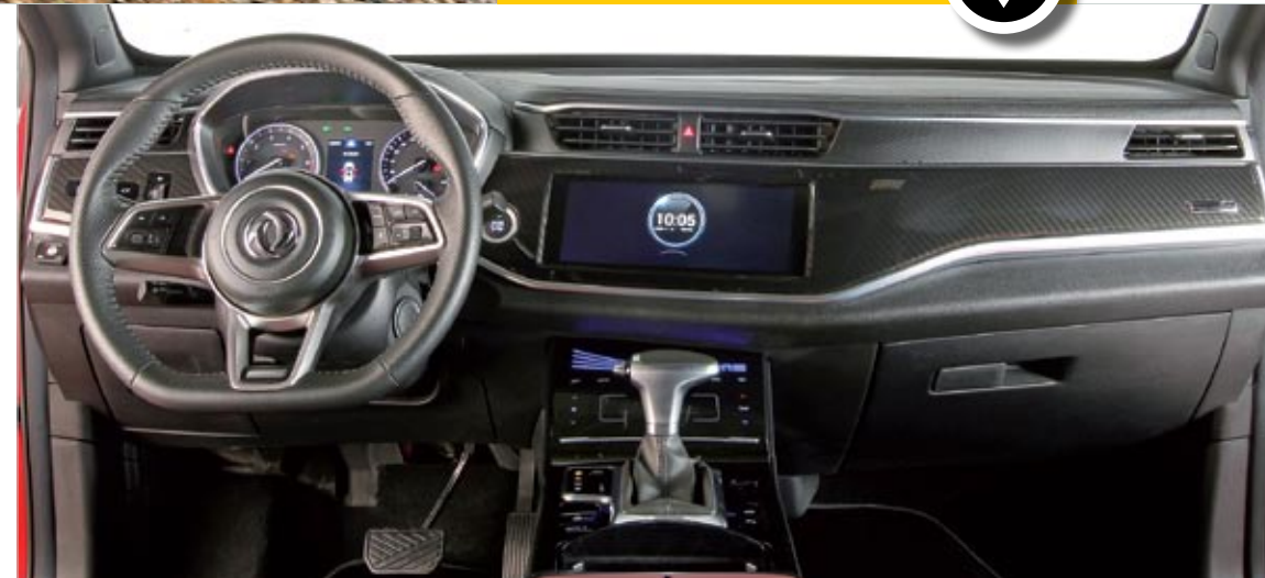
▲ El cambio automático es ZF y de tipo CVT, con un gran resbalamiento que enerva. Tiene simuladas seis marchas y modo secuencial.
