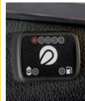
◀ El mando que gestiona el GLP se encuentra a la izquierda del volante. El coche arranca por defecto con GLP, pero se puede cambiar en cualquier momento.
