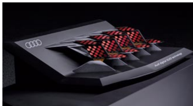
▲ Los pilotos OLED evolucionarán a corto plazo, pues ofrecerán más de 60 segmentos, serán flexibles y medirán 0,7 milímetros de espesor.
