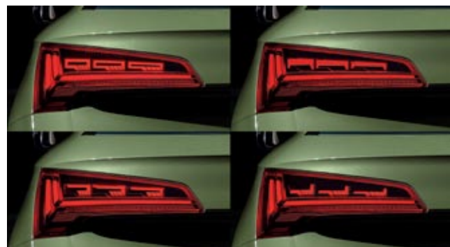
▲ El renovado Audi Q5 ha sido el primer vehículo del mundo en usar pilotos OLED Digitales. Estos ofrecen cuatro gráficos a elegir.
