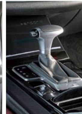
▲ El cambio automático es ZF y de tipo CVT, con un gran resbalamiento que enerva. Tiene simuladas seis marchas y modo secuencial.
