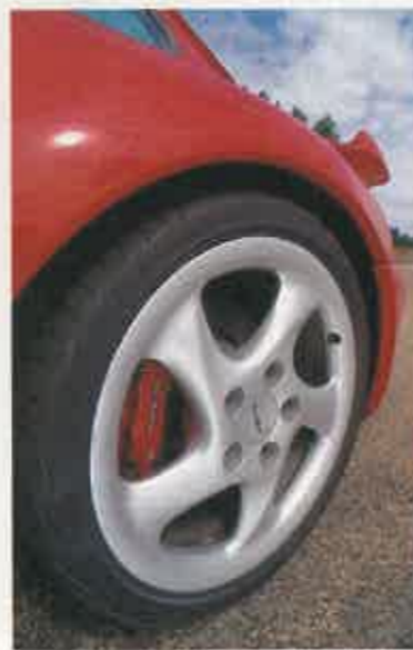
Las llantas de aleación son huecas para aligerar el peso del coche.
