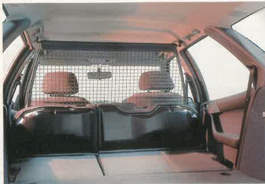
Citroën, en este modelo ofrece opcionalmente una red de protección, un elemento muy práctico que evita, en un frenazo brusco, que la carga golpee a los pasajeros.
