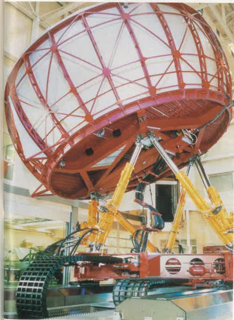
Los técnicos simulan circunstancias de conducción real mientras que el simulador de 18 toneladas se desplaza hasta siete metros.
