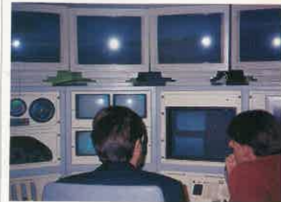
Los técnicos simulan circunstancias de conducción real mientras que el simulador de 18 toneladas se desplaza hasta siete metros.
