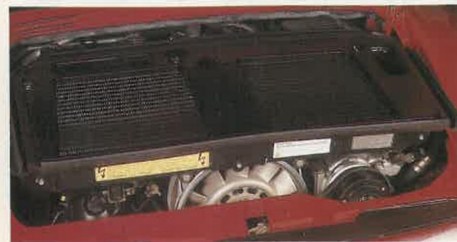
Bajo el alerón posterior del coche se encuentra el potente motor de 408 caballos. Este queda casi oculto por el generoso intercambiador de calor (intercooler).
