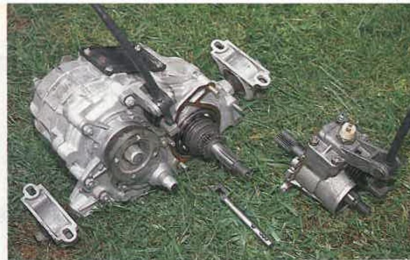
Este sistema de desbloqueo para los Niva, que parece muy complicado pero realmente no lo es, consta tan sólo de tres nuevas piezas: el eje, la arandela y el reenvío de la palanca. Todo ese ubica bajo la misma carcasa, con el mismo engrase ya existente.
