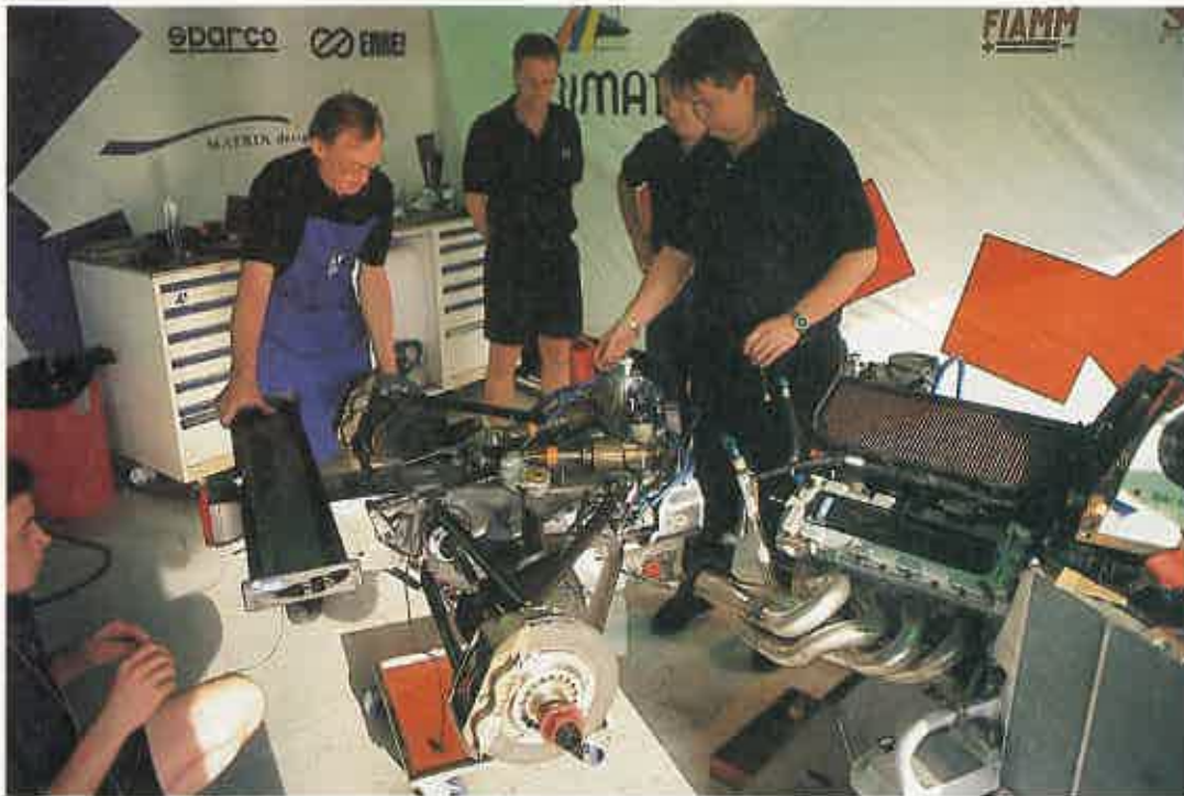
Aquí se puede apreciar la estructura posterior completa recién separada del motor V8 de Brian Hart. Se evidencia la complejidad del conjunto.
