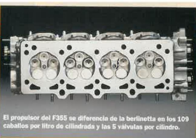
El propulsor del F355 se diferencia de la berlinetta en los 109 caballos por litro de cilindrada y las 5 válvulas por cilindro.
