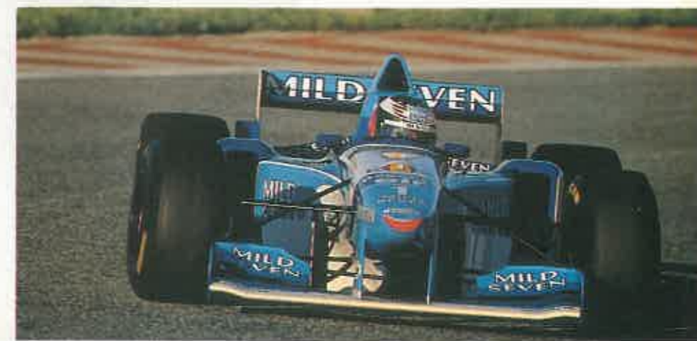
La potencia máxima que es capaz de ofrecer el Benetton B 195 es de 715 CV.
