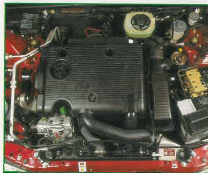
El motor dos litros del Rover 620SDi es de nuevo diseño y ha sido fabricado por completo por la marca inglesa. Con inyección directa de combustible, el bajo consumo es una de sus virtudes.
