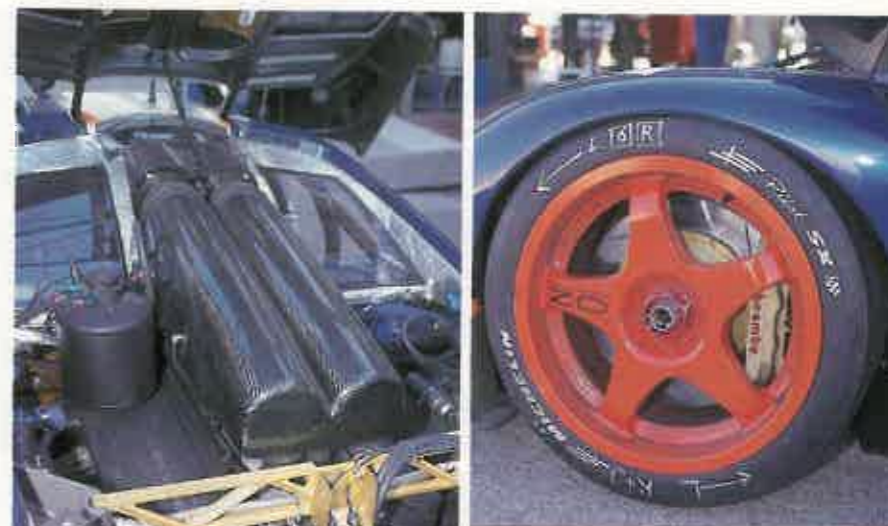
El motor BMW apenas ha cambiado respecto al de serie. Es un V12 que desarrolla una potencia de 640 caballos y un par motor de 75 mkg. Las prestaciones son espectaculares.
