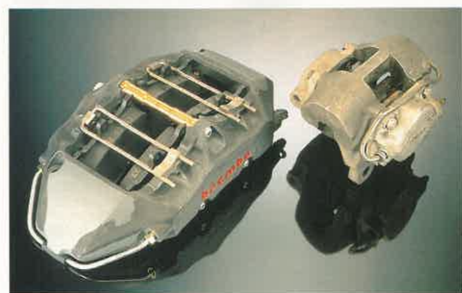
Entre las pinzas de freno Dunlop, con las que venció el Jaguar XK120 de Mamilton en las 24 Horas de Le Mans de 1953 y las actuales pinzas Brembo del DTM hay un avance tecnológico espectacular. A pesar de la diferencia de tamaño y potencia de frenada, las pinzas de Brembo son 800 gramos más ligeras (peso total de 3,150 Kg.)
