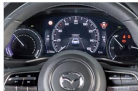
▲▲ La instrumentación es una pantalla digital de 7 pulgadas en la que solo podemos configurar el diseño de una pequeña sección. Y la pantalla central, de formato alargado, se controla desde una rueda, pues no es táctil.
