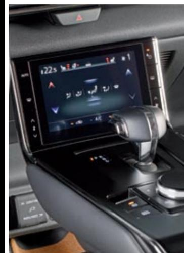
▲▲ En la consola hay un enchufe doméstico de 150W y una pantalla digital táctil específica para la climatización.
