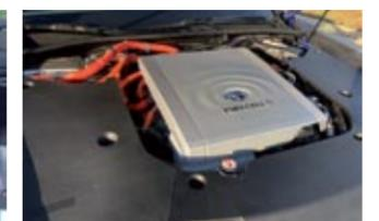
◀▲ La pila de combustible va debajo del capó delantero, y los tres depósitos de hidrógeno bajo el suelo del habitáculo. El motor está acoplado al eje posterior.
