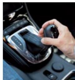
▲ El cambio automático de variador tiene siete marchas prefijadas y admite manejo manual, pero mediante la palanca.
