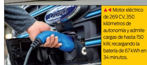
Motor eléctrico de 269 CV, 350 kilómetros de autonomía y admite cargas de hasta 150 kW, recargando la batería de 67 kWh en 34 minutos.
