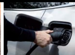
▲ La máxima potencia de carga es 7,4 kW. En esas condiciones, bastan menos de dos horas para concluir.
