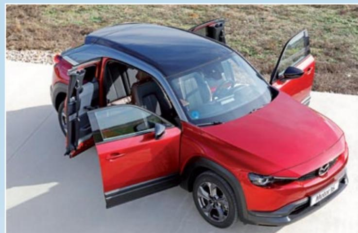
◀ Sorprende que con una longitud de casi 4,40 metros se recurra a un sistema de puertas de apertura opuesta más original que práctico. Para abrir las traseras hay que abrir antes las delanteras, y el acceso a la fila posterior no es muy cómodo.
