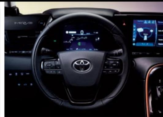
◀ A la izquierda del volante, junto al nombre del coche, va el botón 'H<sub>2</sub>O' que permite purgar el circuito que acumula el agua resultado del funcionamiento de la pila de combustible, y que es la única emisión. Las plazas delanteras son estupendas, pero detrás el espacio es muy justo a lo largo, y el voluminoso túnel central torna casi inutilizable la quinta plaza.
