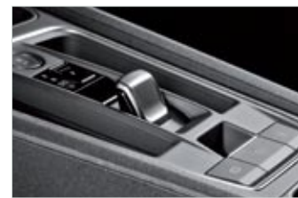
▲ El nuevo selector de las cajas DSG prescinde de la palanca tradicional, de modo que para cambiar manualmente solo se pueden usar las levas del volante. El interior del Formentor tiene detalles prácticos y de calidad.
