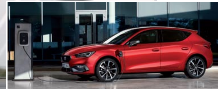
◀ El maletero del León de cinco puertas pierde 90 litros por las baterías, y se queda en solo 270. Para la carga, 5 h 48 minutos en enchufe convencional y 3 h 42 minutos a 3,6 kWh.
