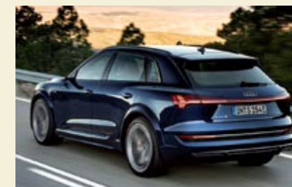
▲ E-TRON S. En 2020 este modelo va un paso más allá en la tracción Quattro eléctrica al disfrutar de vectorización de par en el eje trasero, con un motor en cada rueda trasera.
