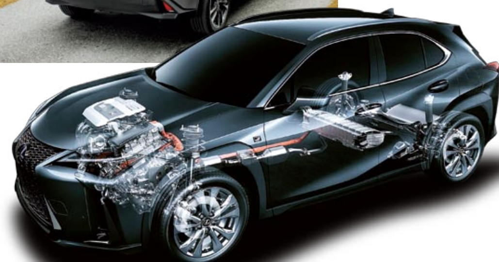
▲▼ El Lexus UX 250h nace desde la nueva plataforma GA-C. Contempla variantes con tracción delantera o total. Estas últimas añaden un motor eléctrico en el eje trasero, aunque la potencia total es la misma.
