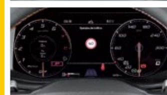
◀ El cuadro de instrumentos digital de 10,25 pulgadas permite elegir entre diseños muy variados, y con muchos datos.
