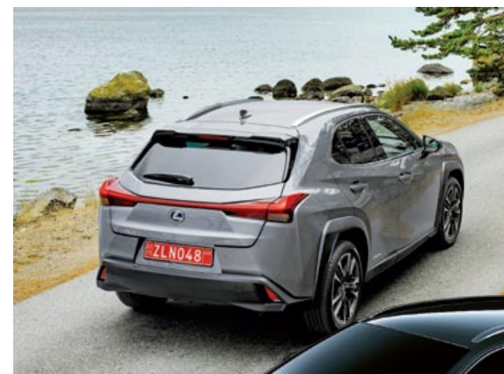
▲▼ El Lexus UX 250h nace desde la nueva plataforma GA-C. Contempla variantes con tracción delantera o total. Estas últimas añaden un motor eléctrico en el eje trasero, aunque la potencia total es la misma.
