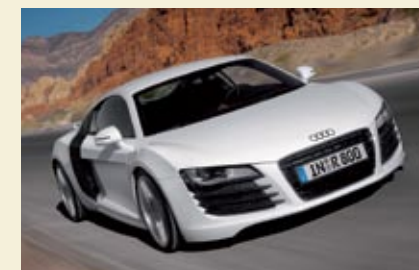
▲ R8. Se lanzó en 2007 y montaba un acoplamiento viscoso multidisco que permitía pasar hasta un 30 por ciento del par a las ruedas delanteras.
