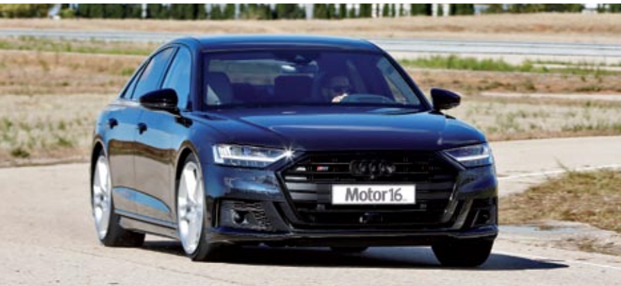
◀ La tecnología de 48 voltios controla las suspensiones neumáticas y sus barras estabilizadoras activas. 4.495 euros es el precio de esos faros con tecnología láser y dotados de 138 LED cada uno.
