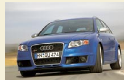
▲ RS 4. En 2005 este modelo con motor longitudinal introducía un nuevo engranaje planetario que en condiciones normales distribuía la fuerza en una proporción 40:60.
