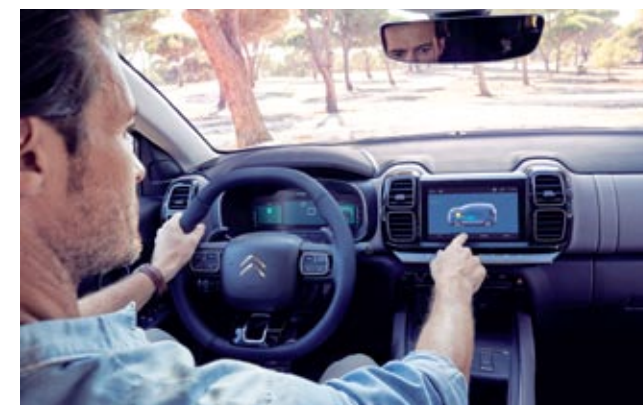
▲ Desde la pantalla central táctil de 8 pulgadas se controlan rápidamente las principales funciones del vehículo. Y la instrumentación también es una pantalla digital: de 12,3 pulgadas y configurable.
