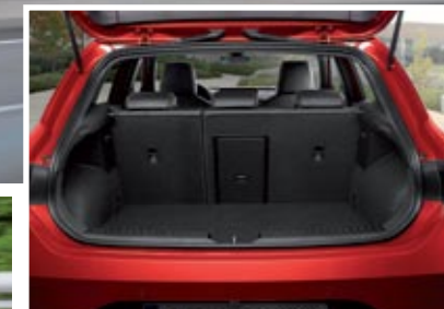
◀ El maletero del León de cinco puertas pierde 90 litros por las baterías, y se queda en solo 270. Para la carga, 5 h 48 minutos en enchufe convencional y 3 h 42 minutos a 3,6 kWh.
