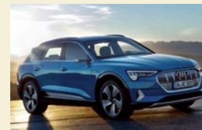
▲ E-TRON. En 2019, el primer modelo eléctrico de Audi introduce la tracción Quattro eléctrica por medio de dos motores eléctricos, ubicado cada uno en un eje.
