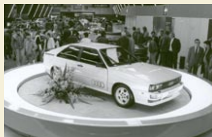
▲ AUDI QUATTRO. El debut de la tecnología Quattro se produjo en el Salón de Ginebra de 1980. Este coupé montaba un motor turbo de cinco cilindros con 200 CV de potencia.
