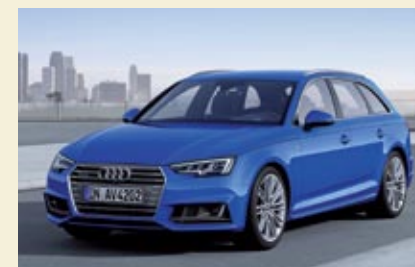
▲ A4. El sistema Quattro Ultra debutó en el A4 en 2016. Su objetivo, ahorrar combustible. Por eso actúa sobre el eje delantero y activa el trasero sólo cuando es necesario.
