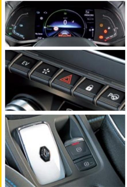
▲ El cuadro de mandos digital es configurable y se ofrece de serie. El modo EV permite circular de manera eléctrica y el freno de estacionamiento es eléctrico con este acabado.
