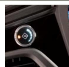
▲ Este mando permite cambiar de GLP a gasolina, o a la inversa, e indica el nivel de gas en el depósito. Esta versión es 4x2, lleva un control de descensos y presume de 18,2 centímetros de altura libre al suelo.
