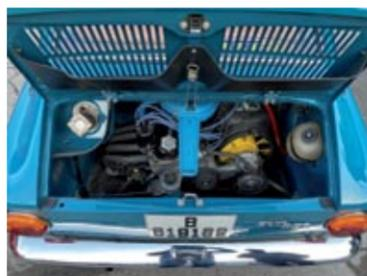
▶▶ La boca de llenado de gasolina está justo al lado del motor, una ubicación peligrosa. La posición de los pedales nos complicó un poco la conducción.
