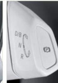
▲ El selector del cambio, del modo 'B' de mayor retención en deceleraciones y del freno de mano van arriba, a la derecha del volante. Al final te acostumbras, pero...
