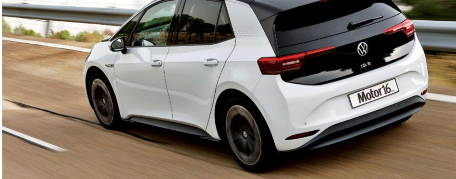
**MUY AERODINÁMICO CON UN ÍNDICE CX DE 0,27 SE LUCHA MEJOR CONTRA EL AIRE A ALTA VELOCIDAD. EL ID.3 ALCANZA 160 KM/H –163 EN LA PRÁCTICA–, MIENTRAS QUE LA PUNTA SE LIMITA A 130 KM/H EN EL MODO ECO BIEN ACABADO, A SU MANERA EL ID.3 ESTÁ MUY BIEN HECHO, PERO DETALLES O MATERIALES NO SON LOS DE UN GOLF. SU FILOSOFÍA ES MÁS AUSTERA**
