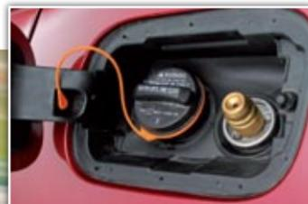
◀ Junto a la boca del depósito o de gasolina añade una toma específica para alimentarse de GLP.
