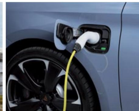
◀ El Cupra León e-Hybrid puede recargarse en un enchufe de 3,6 kW en 3 horas y 42 minutos. Y esta carga daría para recorrer hasta 52 kilómetros en modo eléctrico. De hecho, disfruta de la etiqueta 0 de la DGT.
