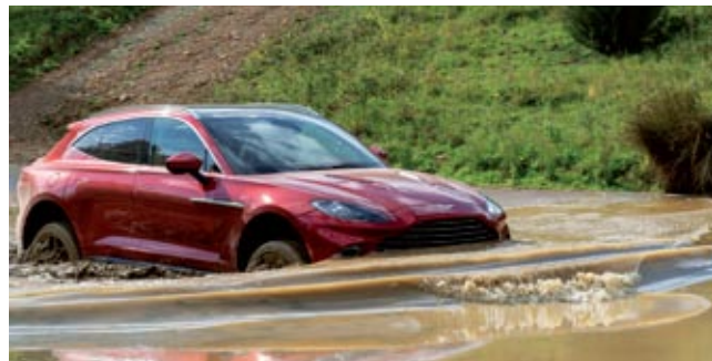
▲ Gracias a la suspensión regulable en altura, el DBX puede vadear ríos o zonas inundadas con hasta 500 milímetros de profundidad.
