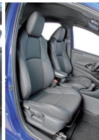
► La terminación del interior se remata con más esmero. Nos han gustado las butacas delanteras, muy deportivas, y entre ellas hay ahora un airbag central. Debajo del asiento trasero se ubica la batería de iones de litio, y también la auxiliar de 12 voltios.
