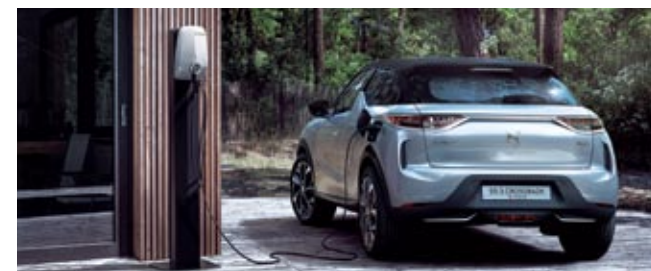
▲ Los 50 kWh de su batería se pueden recargar hasta en tomas de 100 kW. Con el cargador de 7,4, el tiempo para llenarla es de 8 horas.
