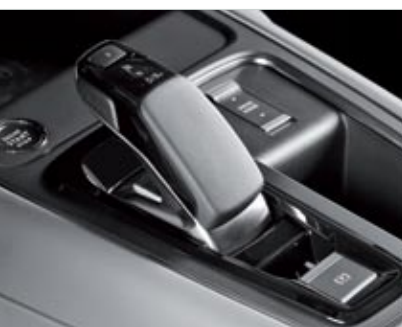
▲▲ El cambio automático es el EAT8, adaptado a mecánicas híbridas. Es igual de suave, tiene un modo B que acentúa la retención y puede ser usado manualmente con las levas.
