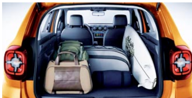
▲ El maletero del Dacia Duster de GLP cubica 445 litros. Sin embargo, no puede llevar rueda de repuesto, sustituida por un kit de reparación.
