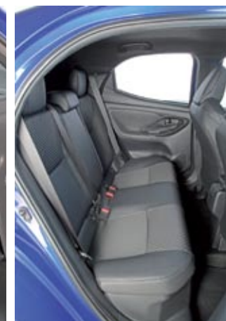
► La terminación del interior se remata con más esmero. Nos han gustado las butacas delanteras, muy deportivas, y entre ellas hay ahora un airbag central. Debajo del asiento trasero se ubica la batería de iones de litio, y también la auxiliar de 12 voltios.
