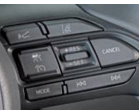
▲ El control de crucero adaptativo forma parte de la dotación de serie. También el asistente de conducción, con los programas Eco, Normal y Sport, más el modo EV totalmente eléctrico.
