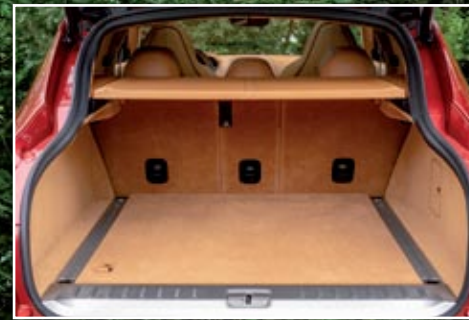
◀▶ El maletero del primer Aston Martin todocamino ofrece un volumen de 632 litros tras los asientos, más 62 bajo el piso. Con el modo 'Terrain Plus' activado la suspensión se eleva 50 milímetros.
