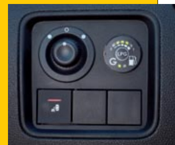
▲ A la derecha del volante, junto al botón de regulación de los espejos, se encuentra el mando de selección de GLP.
