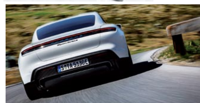
◀ Porsche ha recurrido a la tecnología de los 800 voltios para su sistema eléctrico. Las baterías van situadas en el piso.
