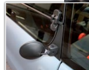
▲ Como emplea la misma puerta a ambos lados, una abre hacia delante y la otra, hacia atrás. La ventanilla abatible puede rozar el espejo –difícil de ajustar desde dentro– y descolocarlo.
