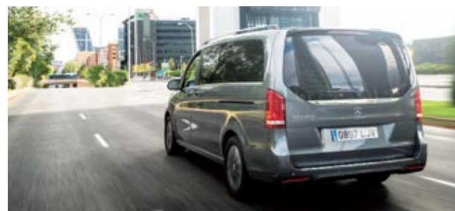
▲ La EQV es una furgoneta eléctrica de lujo con el equivalente a 204 CV. En uso real por ciudad hemos medido un gasto de 27 kWh/100 km.
