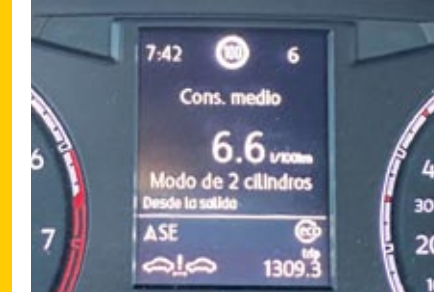
▲ Cuando menos te lo esperas, en el motor dejan de funcionar dos de los cuatro cilindros para ahorrar. Ocurre al llanear a punta de gas.
