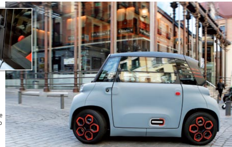
▲ Como emplea la misma puerta a ambos lados, una abre hacia delante y la otra, hacia atrás. La ventanilla abatible puede rozar el espejo –difícil de ajustar desde dentro– y descolocarlo.
