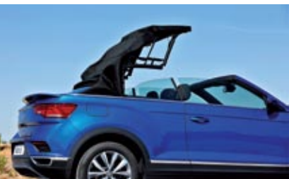
▲▼ El techo de lona de alta calidad del T-Roc Cabrio se abre en 9 segundos y se cierra en 11, y todo ello puede hacerse a una velocidad de hasta 30 km/h.
