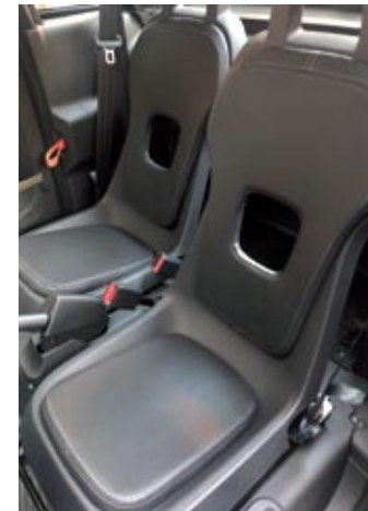
▲ Dos asientos, con el del copiloto algo más retrasado. Los botones D, N y R del cambio van a la izquierda.
