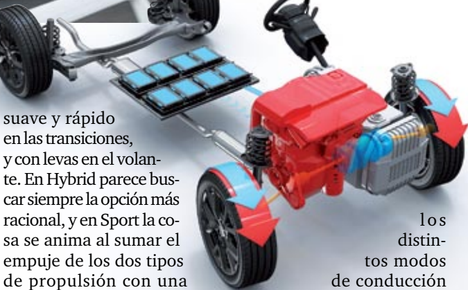
◀▶ Las baterías van bajo el suelo de los asientos traseros. La nueva suspensión multibrazo trasera resta 120 litros al maletero, que sigue siendo muy grande.
