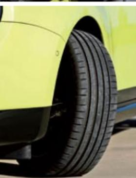
▲ Las ruedas delanteras giran muchísimo y permiten un radio de giro récord.
