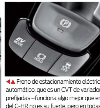
◀▲ Freno de estacionamiento eléctrico de serie, como el cambio automático, que es un CVT de variador continuo con seis marchas prefijadas –funciona algo mejor que en la versión 125H–. La amplitud del C-HR no es su fuerte, pero en todas las cotas supera al Puma.
