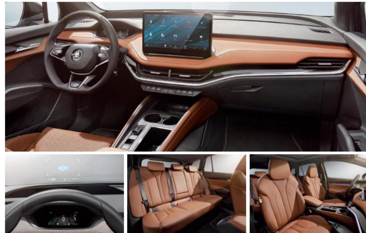
◀ Buena parte de sus funciones se controlan desde la pantalla de 13 pulgadas –es de 10 en las versiones 50 iV–, y ofrece un avanzado control por voz. Dentro se usan materiales reciclados y otros tratados de manera natural, como el tapizado de la imagen, curtido con aceite de oliva. Y hay diferentes ambientes para personalizarlo a nuestro gusto.
