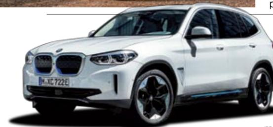
**BMW iX3.-** La batería de quinta generación BMW eDrive, con la última tecnología de celdas y una capacidad de 80 kWh, permite que el nuevo iX3 cien por cien eléctrico anuncie una autonomía de hasta 460 kilómetros en el ciclo mixto WLTP. El BMW iX3
