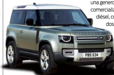
–4,58 con rueda de repuesto– y presenta una capacidad 'off road' extraordinaria, gracias a aliados como el Terrain Response, la caja reductora, la tracción total y una generosa altura al suelo. Se comercializa con dos motores diésel, con 200 y 240 CV, y dos más de gasolina, con 300 y 400 CV, el más potente asociado a un sistema híbrido ligero de 48V. El cambio siempre es automático de ocho relaciones.
