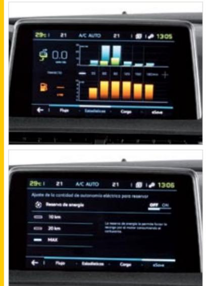
▶ Desde la pantalla central se controla el sistema híbrido. El mando Drive Mode va junto al cambio, que tiene un programa B que genera retención y más recarga al decelerar; algo muy útil en ciudad o bajando un puerto.
