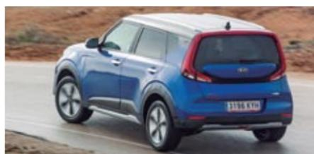
◀ Al límite se nota el mayor peso del e-Soul, pues la batería de 64 kW supone 457 de los 1.682 kilos del conjunto.
