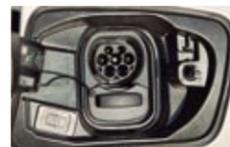
◀ El cargador de a bordo del DS permite conexiones a 7,4 y 11 kW.
