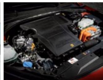
▲ Esta versión PHEV homologa un consumo medio de 1,4 litros. Agotando la batería y los 37 litros del depósito de gasolina la autonomía total ronda los 700 kilómetros.
