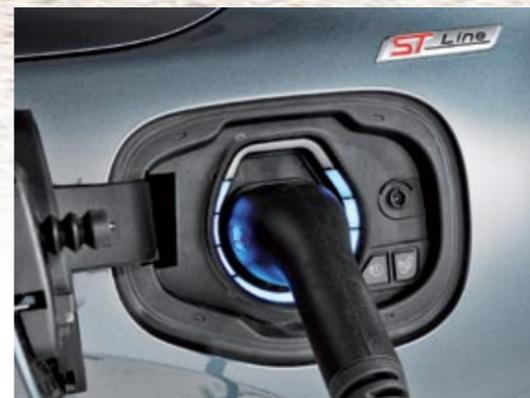
◀ La batería de 14,4 kWh –10,6 útiles– se puede recargar en un enchufe doméstico en menos de 6 horas, y un sistema de luces indica cómo va el proceso. En marcha, la recarga es muy activa, y 'fabrica' mucha electricidad.
