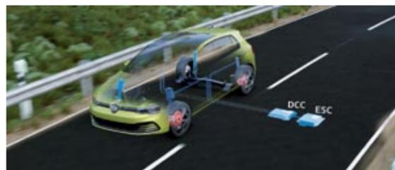
▶ El Gestor de la Dinámica de Marcha controla la suspensión regulable DCC (830 euros muy bien invertidos) y el ESC para lograr la mejor estabilidad.
