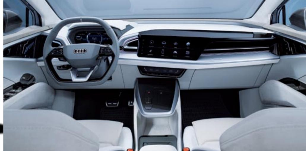
▲ Gracias a la generosa distancia entre ejes –2,77 metros– y a la ausencia de túnel central, se anuncia una amplitud excelente. La pantalla central táctil es de 12,3 pulgadas, y la instrumentación, el Audi Virtual Cockpit.
