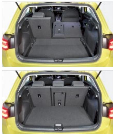
◀ El piso del maletero se puede colocar a dos alturas diferentes. Y los respaldos, abatir por partes asimétricas. Rebosa calidad por los cuatro costados.
