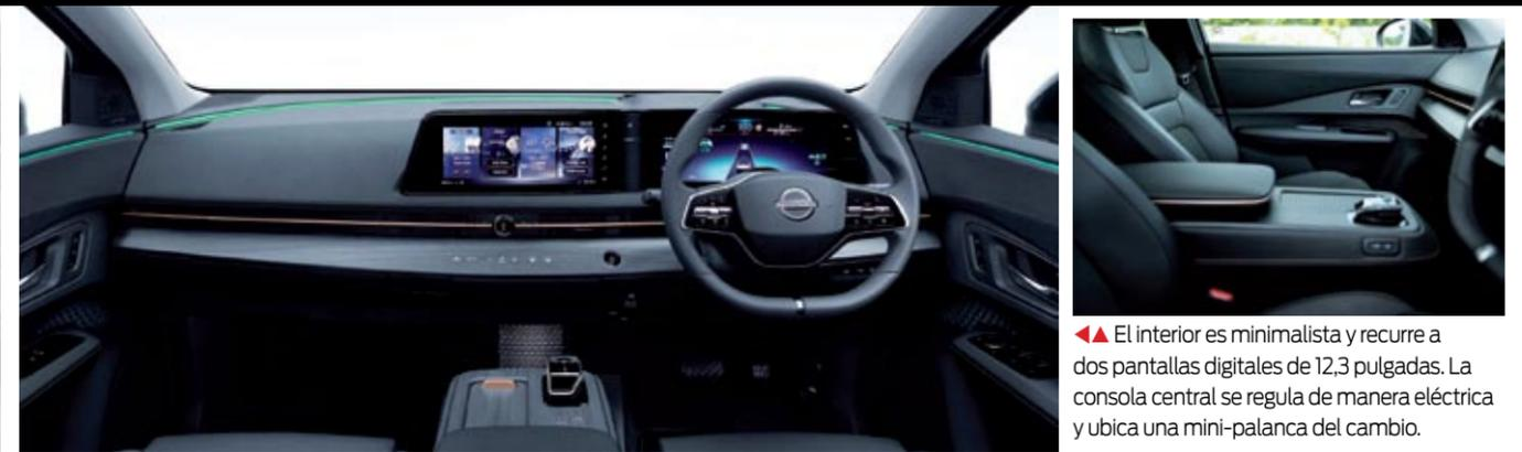
◀ El interior es minimalista y recurre a dos pantallas digitales de 12,3 pulgadas. La consola central se regula de manera eléctrica y ubica una mini-palanca del cambio.
