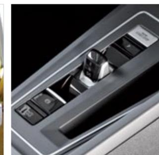
▶ El cambio DSG recurre a una palanca de tamaño reducido que funciona de manera electrónica sin conexión mecánica. Las levas del volante son algo pequeñas.
