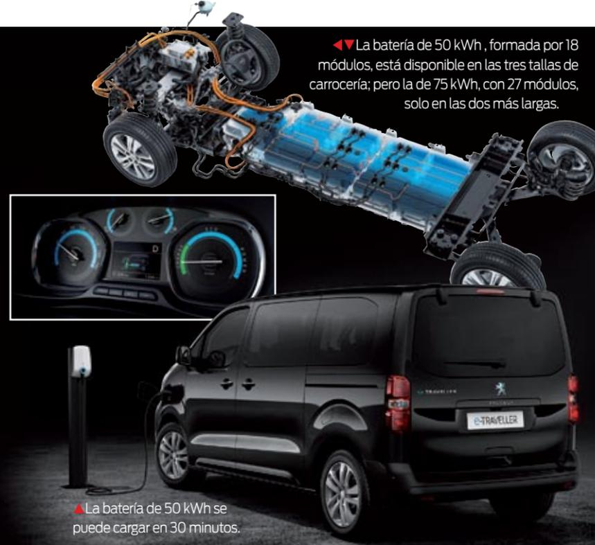
◀◀ La batería de 50 kWh, formada por 18 módulos, está disponible en las tres tallas de carrocería; pero la de 75 kWh, con 27 módulos, solo en las dos más largas.
