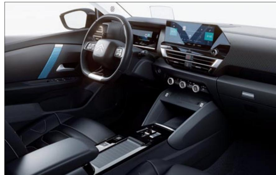
▲ Instrumentación digital y con Head-up Display a color. El salpicadero está presidido por una pantalla táctil ultrafina de 10 pulgadas y el climatizador tiene mandos 'de verdad' en la consola.
