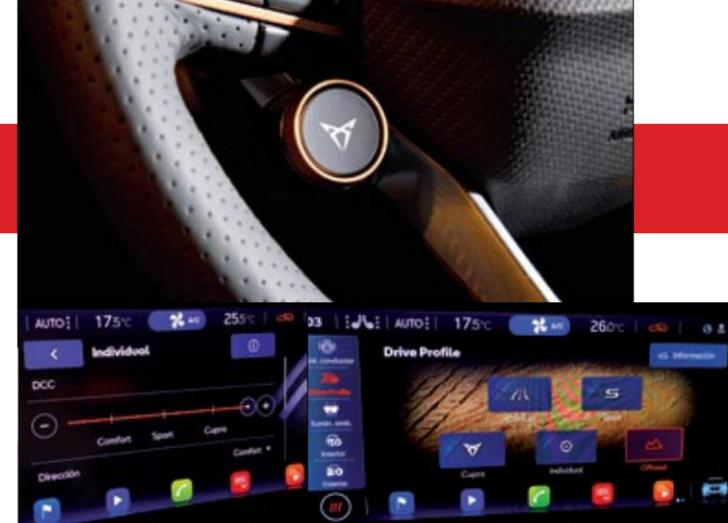
▶ En el Drive Profile de la pantalla se pueden modificar los modos de conducción. Y en el Individual ya se puede regular la dureza de la suspensión, incluso con más firmeza que en el modo Cupra.
