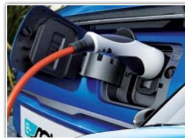
◀ La toma de corriente se ubica en el frontal y admite cargas de hasta 80 kW.
