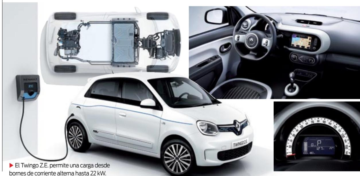
► El Twingo Z.E. permite una carga desde bornes de corriente alterna hasta 22 kW.
