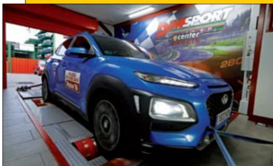
▶▶ En la pantalla central se puede visualizar el trabajo del sistema híbrido. En el Banco de Potencia de DimSport hemos comprobado la potencia de este modelo en función de la carga de la batería.
