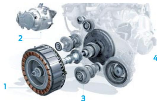
▲ 1.- Motor eléctrico de alta potencia. 2.- Motor eléctrico generador
