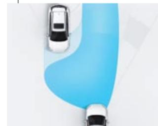
◀ El sistema activo de luces largas HBA tiene un modo automático en el que detecta si esta posición de los faros LED puede molestar.
