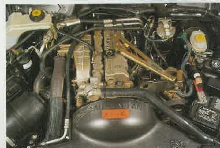
El nuevo motor del Cherokee es el turbodiesel que ya utiliza el Voyager. Es un motor de gran elasticidad que permite mantener buenos cruceros en carretera.
