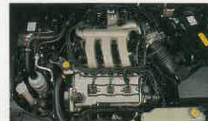
El motor de 6 cilindros en V, 24 válvulas y 170 caballos de potencia, poco elástico.
