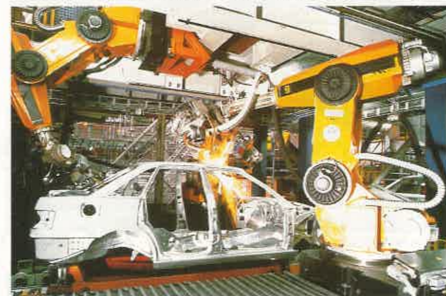
Las carrocerías en bruto son soldadas por robots industriales. Todo el primer proceso de producción está completamente automatizado.
