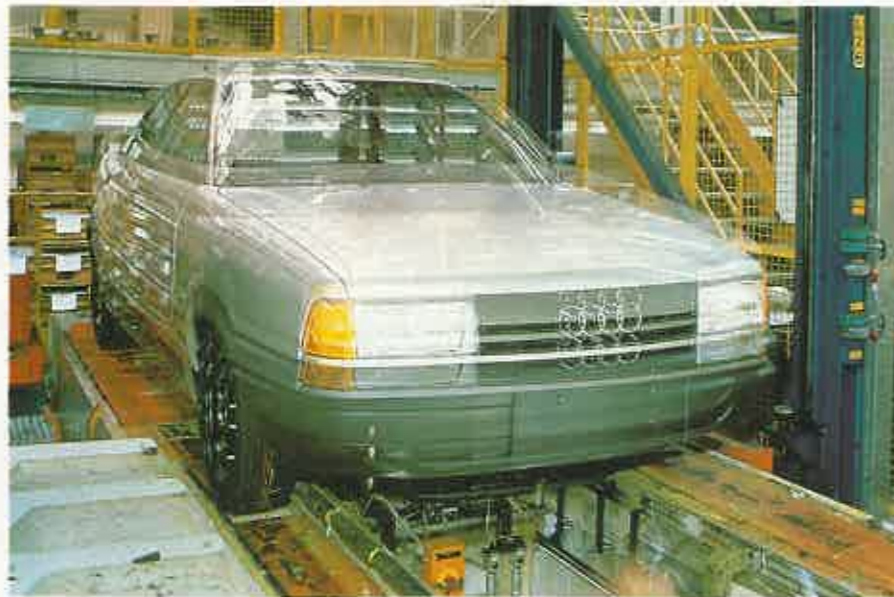
En el banco vibratorio los coches son sometidos a durísimos esfuerzos. Cualquier elemento mal apretado o que no encaje se detecta con facilidad.
