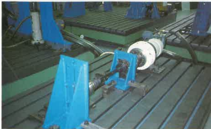
Las transmisiones se someten durante largo tiempo a prueba. Las condiciones simuladas son mucho más duras que las del uso cotidiano.
