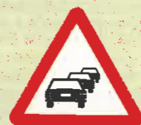
Congestión: Peligro por la proximidad de un tramo congestionado.
