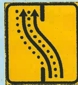
Desvío de dos carriles por calzada opuesta.
