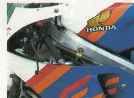
El chasis es de aluminio Tiene forma de «U»
