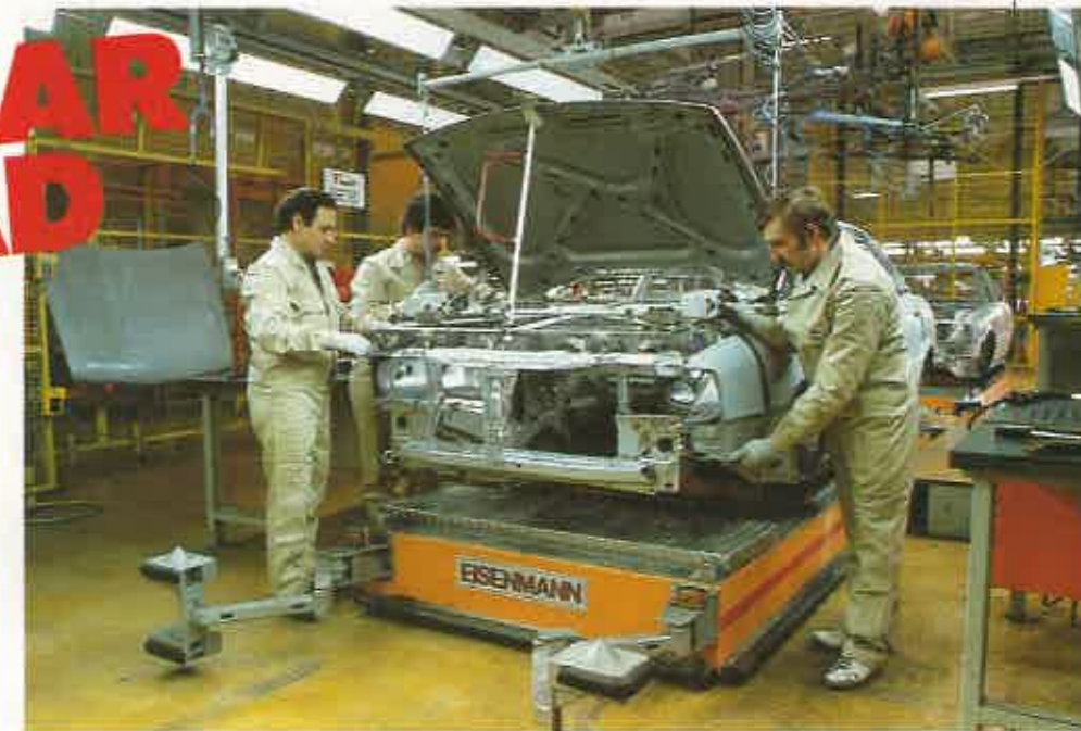
Los carros de transporte sin conductor sustituyen a las cadenas de montaje. Los obreros trabajan en grupos y no ponen el carro en marcha hasta que han terminado.
