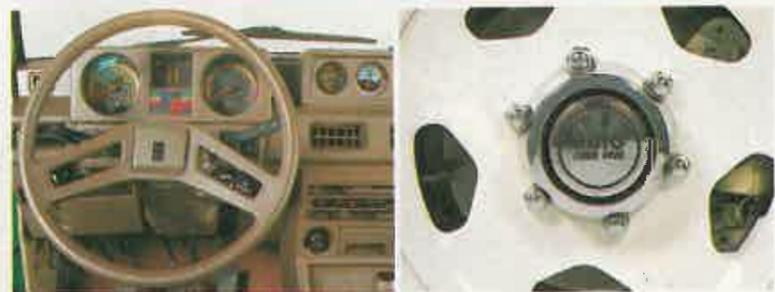
La instrumentación de los Montero es muy completa, y además montan un mecanismo de bloqueo de ruedas automático.
