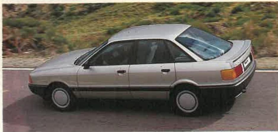
El Audi 80 Quattro es una de las berlinas más seguras. Además de la tracción a las cuatro ruedas, incorpora un sistema antibloqueo de frenos y un ingenioso sistema, denominado Procon-Ten, que impide a la columna de la dirección penetrar en el habitáculo y causar lesiones al conductor en caso de choque frontal.
