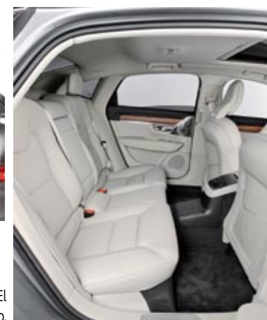
► La habitabilidad es muy generosa y los asientos, muy confortables. El túnel central es voluminoso porque 'esconde' la batería de iones de litio.
