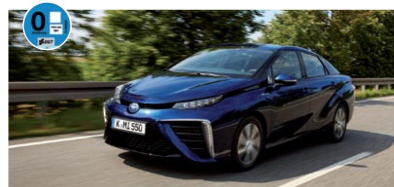
El Mirai es un coche de pila de combustible, un dispositivo que hace reaccionar el hidrógeno con el oxígeno para producir electricidad.
