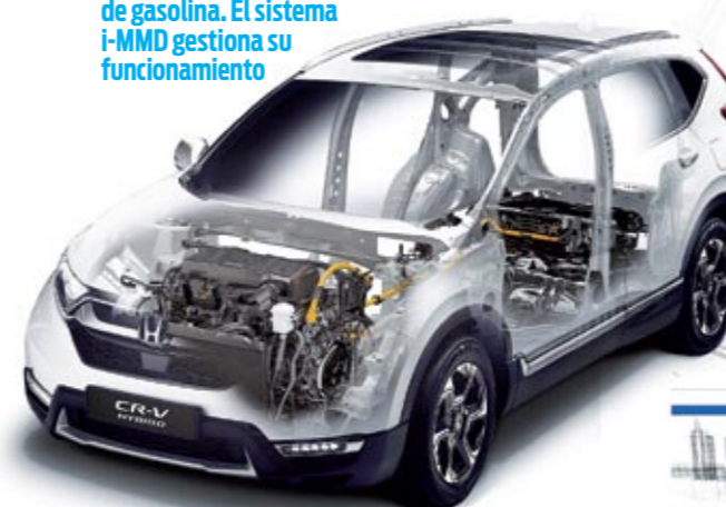
Esta es la radiografía del Honda CR-V Hybrid con las baterías situadas en la parte trasera y el motor térmico en el vano delantero, donde lo llevan los CR-V 'normales'.
