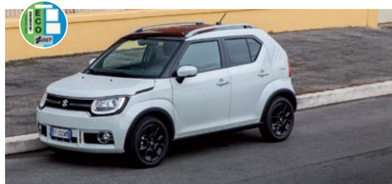
Aunque dispone de versiones de tracción total, el Suzuki Ignis con tecnología Mild Hybrid lleva el par únicamente al eje delantero.
