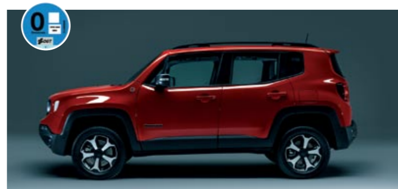
El Renegade será el primer híbrido enchufable de Jeep, con el motor eléctrico moviendo las ruedas traseras para dotarle de tracción total.
