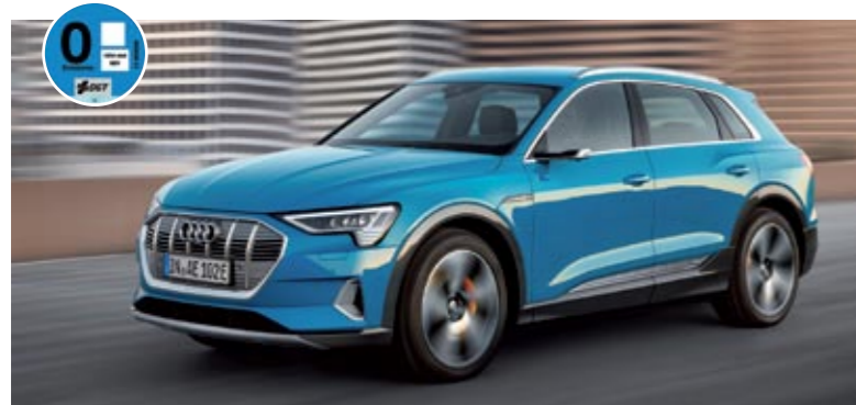
La autonomía real del e-tron, manteniendo unas cifras de consumo en torno a 25 kWh, está en unos 350 km. Dispone de tracción quattro y suspensión neumática.
