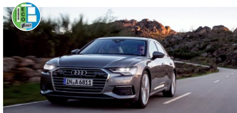
La tecnología MHEV les permite funcionar en modo • inercia entre 55 y 160km/h en todos los motores y la función start-stop actúa entre los 7 y los 22 km/h
