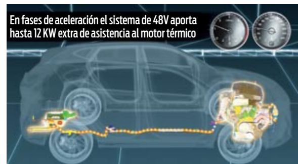
En fases de desaceleración o frenada la energía que se genera se acumula en la batería de 48V.
