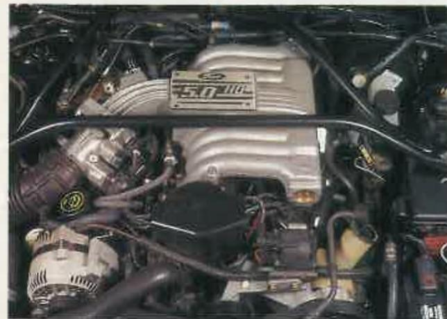
El motor de cinco litros y 8 cilindros en V da 218 caballos. La capota es eléctrica.
