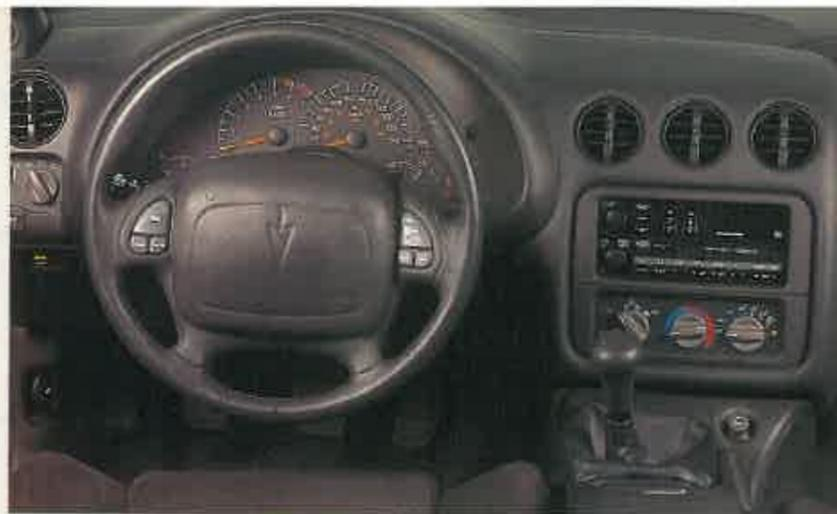
El cuadro de instrumentos es muy completo, incluyendo manómetro de aceite, voltímetro y numerosos testigos luminosos. En el volante, los mandos de la radio.
