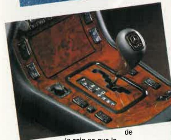
de la caja es que la gestión electrónica de la misma se adapta a la forma de conducir y se anticipa al conductor reduciendo velocidades en las bajadas o ante una curva. A esto se suma el esfuerzo realizado en diseño y materiales, con lo que se consigue un ahorro de un 30 por ciento en peso. Esta primavera todos los Mercedes con motor de 12 cilindros dispondrán de esta caja de cambios.
