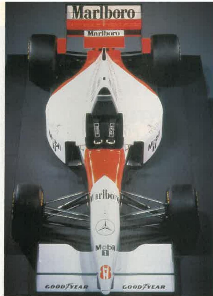
La configuración aerodinámica del McLaren MP4/10 parece un tanto exasperada. El pequeño alerón central y el amplio empleo de la fibra de carbono es destacable.
