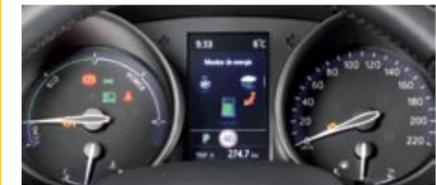
▶ Desde la pantalla central de 8 pulgadas se puede seguir el historial de consumos u observar el funcionamiento, en tiempo real, del sistema híbrido: motor de gasolina y eléctrico, batería...
