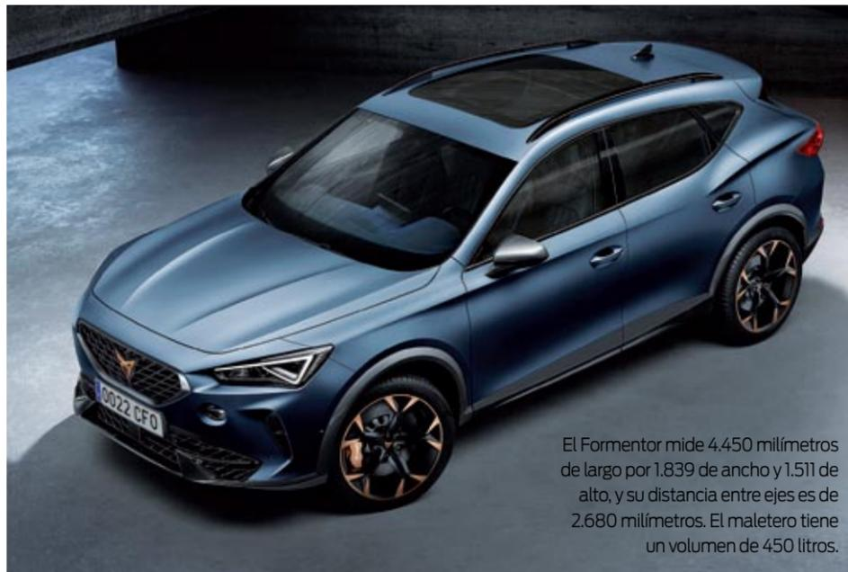
El Formentor mide 4.450 milímetros de largo por 1.839 de ancho y 1.511 de alto, y su distancia entre ejes es de 2.680 milímetros. El maletero tiene un volumen de 450 litros.
