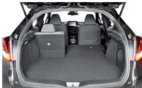
◀ El maletero cubica 358 litros, un volumen no demasiado generoso con respecto a sus rivales. Pierde 19 litros porque bajo el piso se instala la batería auxiliar de 12V, que no cabe bajo el capó delantero debido al mayor cubicaje del motor.
