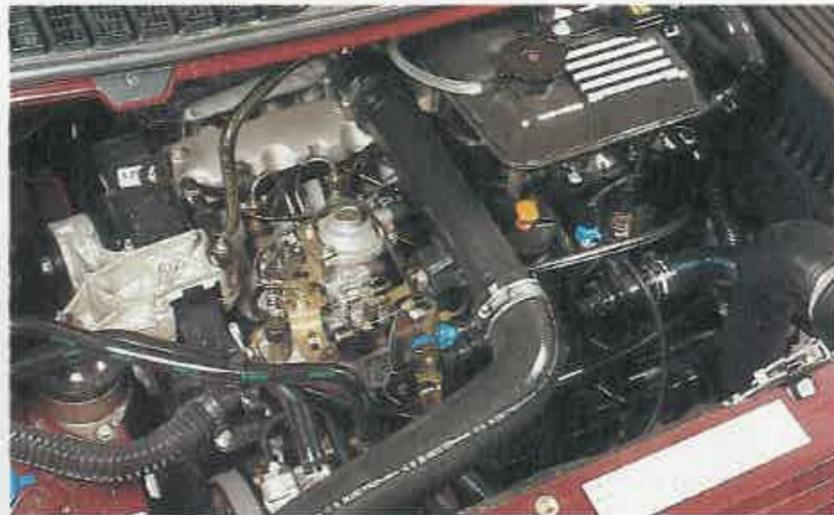
El motor que ofrecen estos dos modelos es el conocido turbodiesel de 92 caballos de potencia creado por el grupo PSA y utilizado en modelos de Citroën y Peugeot.
