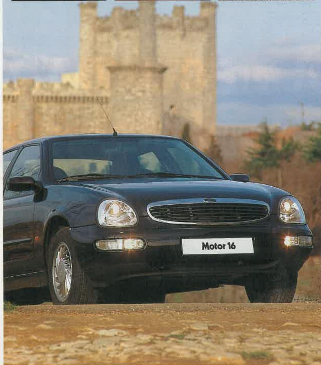
El nuevo modelo de Ford conserva la tracción a las ruedas traseras. Para mejorar su comportamiento incorpora un mecanismo de control de tracción que se acciona desde el interior.
