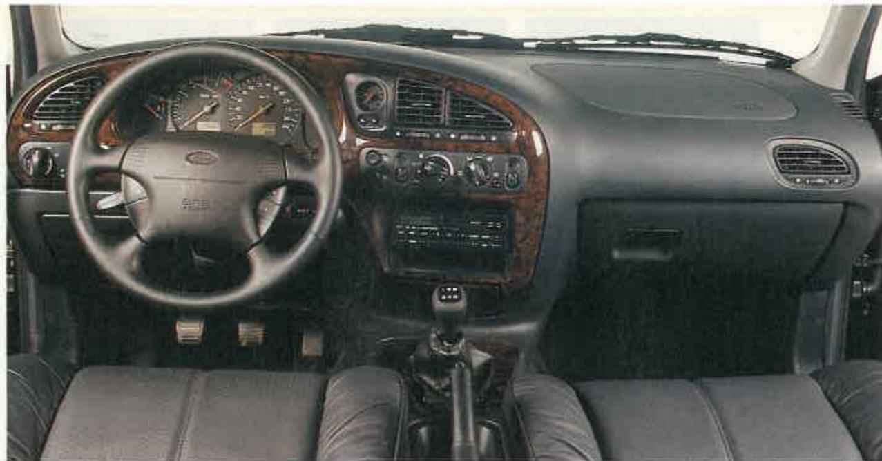
En la columna de la dirección se aprecian varios mandos supletorios. El de la parte izquierda sirve para manejar la radio sin necesidad de soltar las manos del volante, es opcional. El de la derecha mantiene constante una velocidad previamente establecida.
