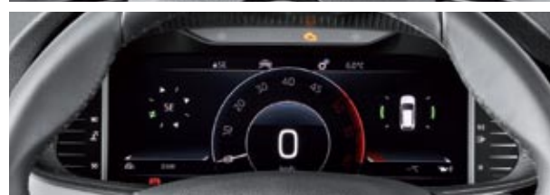
▲ La instrumentación digital Virtual Cockpit, de serie, permite configurar el diseño del área central, donde podemos incluir el mapa de navegación. Desde la pantalla central, de 8 pulgadas, se escoge el programa de conducción si equipamos –105 euros– Drive Mode Select.
