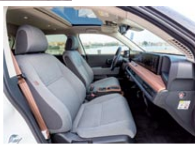
◀▶ El espacio para cuatro ocupantes es más generoso del esperado. Pero el piso está más elevado de lo normal porque debajo va colocada la batería.
