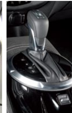
▲ El cambio automático de doble embrague y 7 marchas tiene levas en el volante, pero es algo lento y brusco a baja velocidad.
