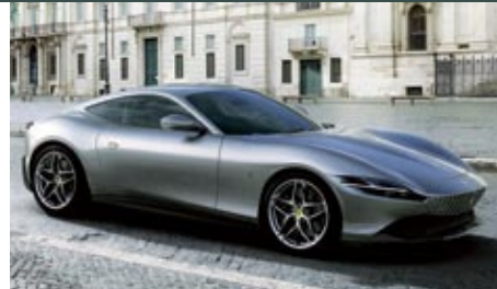
▲ El Roma pesa 1.645 kilos y presume de aerodinámica. Por ejemplo, el alerón trasero móvil tiene tres posiciones, según la velocidad: hasta 100 km/h, de 100 a 300... y más de 300 km/h.
