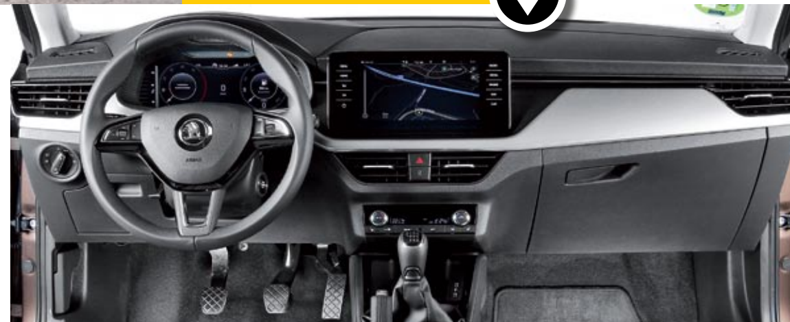
▲ La instrumentación digital Virtual Cockpit, de serie, permite configurar el diseño del área central, donde podemos incluir el mapa de navegación. Desde la pantalla central, de 8 pulgadas, se escoge el programa de conducción si equipamos –105 euros– Drive Mode Select.
