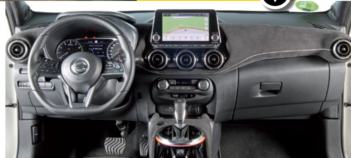
▲ El cambio automático de doble embrague y 7 marchas tiene levas en el volante, pero es algo lento y brusco a baja velocidad.
