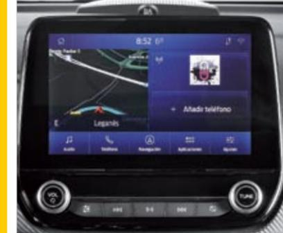
▼▲ La pantalla central táctil da bastante juego, pues permite ver varias informaciones a la vez. Y la instrumentación digital se reconfigura en función del modo de conducción elegido.
