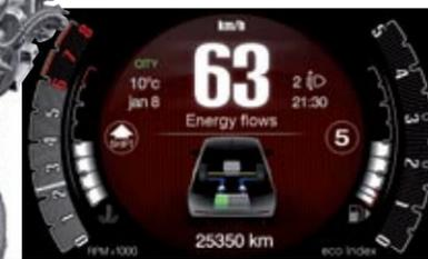
◀▶ El motor tiene tres cilindros y 70 CV. Los gráficos del cuadro representan las diferentes fases del sistema Mild Hybrid. El tapizado de los asientos está realizado a partir de botellas de plástico recogidas, en parte, en el mar.
