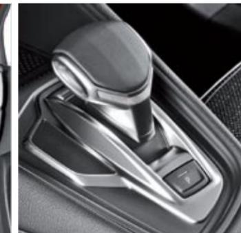
▲ El cambio es automático de siete marchas y la palanca es electrónica, sin cable mecánico.
