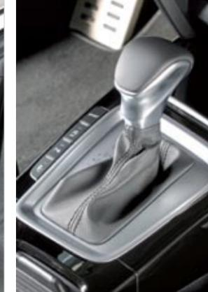
▲ El cambio automático DCT de siete marchas. Funciona bien, aunque le faltan las levas del volante. Tiene modo Sport.
