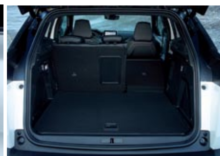
◀ El 3008 Hybrid4 pierde maletero por la presencia de un segundo motor eléctrico bajo el plano de carga. Anuncia 395 litros.
