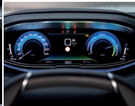
▲ El acabado general es muy bueno y el puesto de conducción tiene diseño i-Cockpit, con volante pequeño e instrumentación —específica para esta versión híbrida— sobreelevada. La pantalla central ofrece datos sobre eficiencia y permite preservar la carga de la batería o programar su recarga.
