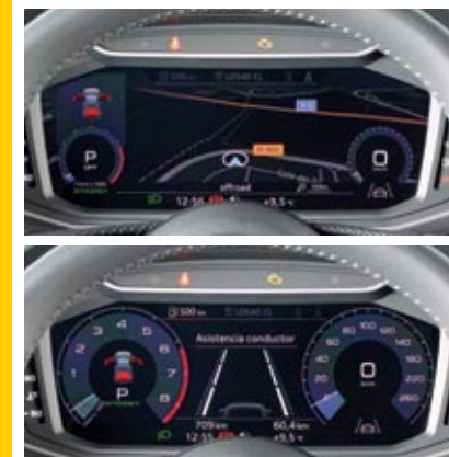
▲▼ El sistema Audi Virtual Cockpit, de múltiples pantallas digitales, es de serie en la versión de lanzamiento. Se cambia el diseño presionando un botón.
