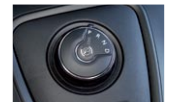
▲ El cambio EAT8 se gestiona con este mando giratorio y desde las levas del volante.
