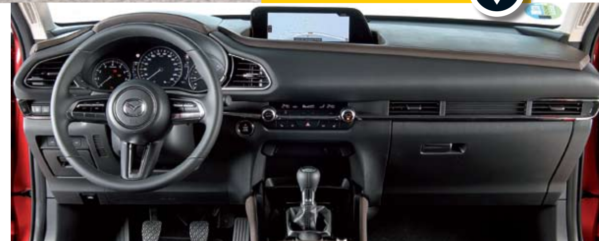
▲ El volante multifunción y el cuadro de mandos son fáciles de gestionar y leer. El sistema SPCCI se ilumina en verde cuando el vehículo funciona con mezcla pobre. Lo hace muy a menudo.
