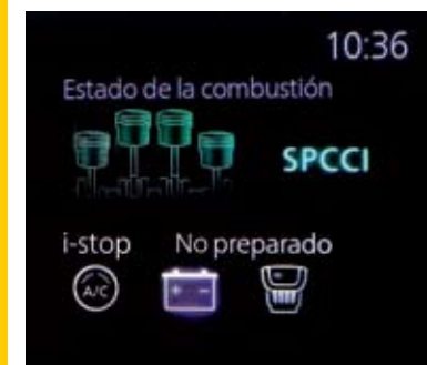
▲ El volante multifunción y el cuadro de mandos son fáciles de gestionar y leer. El sistema SPCCI se ilumina en verde cuando el vehículo funciona con mezcla pobre. Lo hace muy a menudo.
