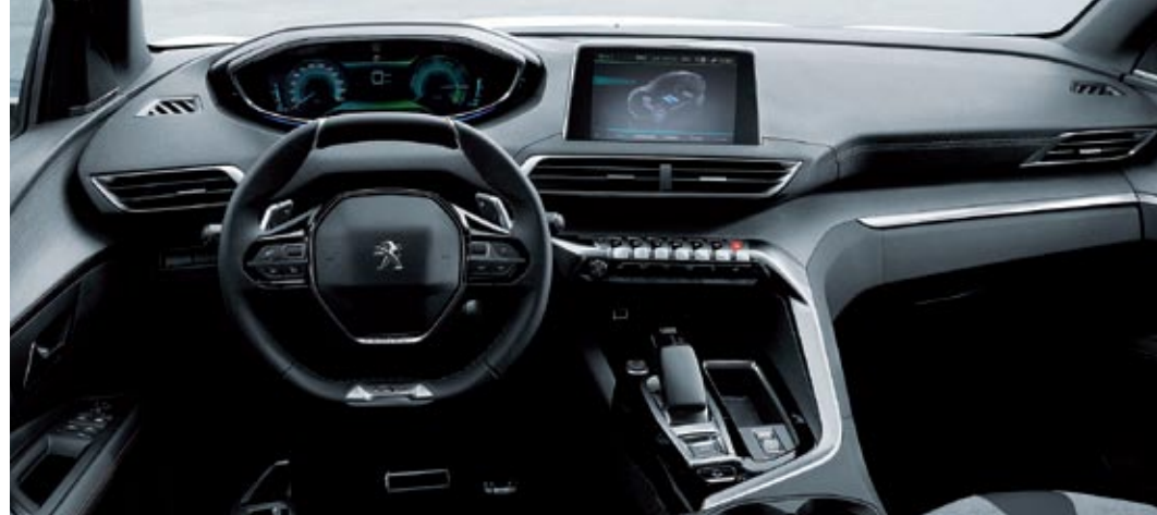
▲ El acabado general es muy bueno y el puesto de conducción tiene diseño i-Cockpit, con volante pequeño e instrumentación —específica para esta versión híbrida— sobreelevada. La pantalla central ofrece datos sobre eficiencia y permite preservar la carga de la batería o programar su recarga.
