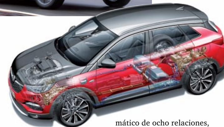
◀◀ La tracción total es un plus por dinamismo y seguridad. El motor eléctrico trasero siempre está vigilante. La batería se ubica debajo de los asientos traseros.
