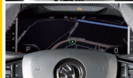
▲ La instrumentación Virtual Cockpit permite configurar el diseño de la parte central, pero los relojes de ambos extremos permanecen fijos.
